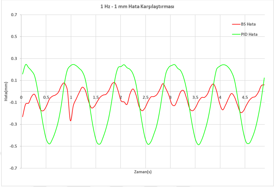
Şekil 5.29 1 Hz frekansta, 1.5 mm pozitif ötelemede ve 1 mm genlikte LOGAK ve PID kontrolcü için hata değerleri
