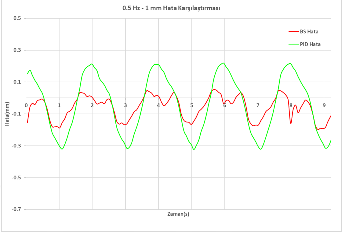
Şekil 5.23 0.5 Hz frekansta, 1.5 mm pozitif ötelemede ve 1 mm genlikte LOGAK ve PID kontrolcü için hata değerleri
