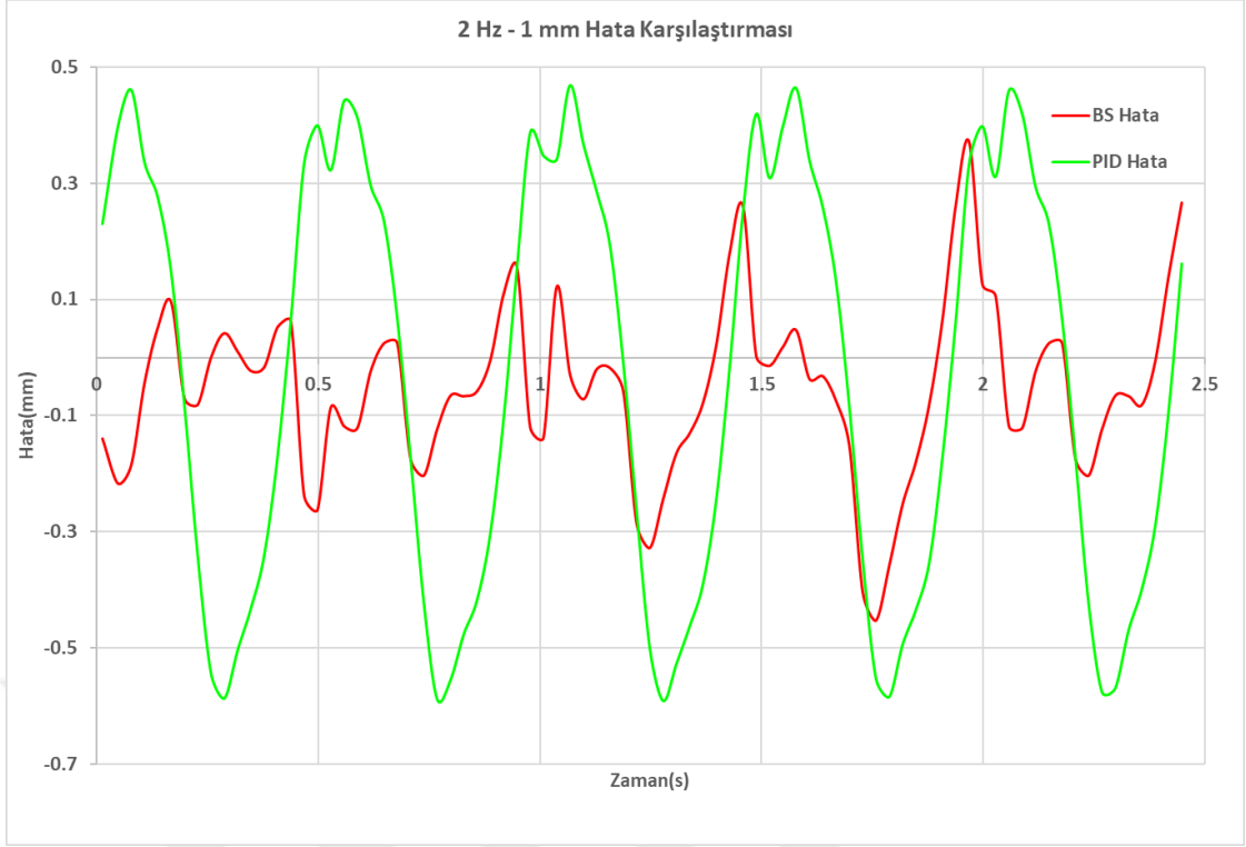
Şekil 5.35 2 Hz frekansta, 1.5 mm pozitif ötelemede ve 1 mm genlikte LOGAK ve PID kontrolcü için hata değerleri
