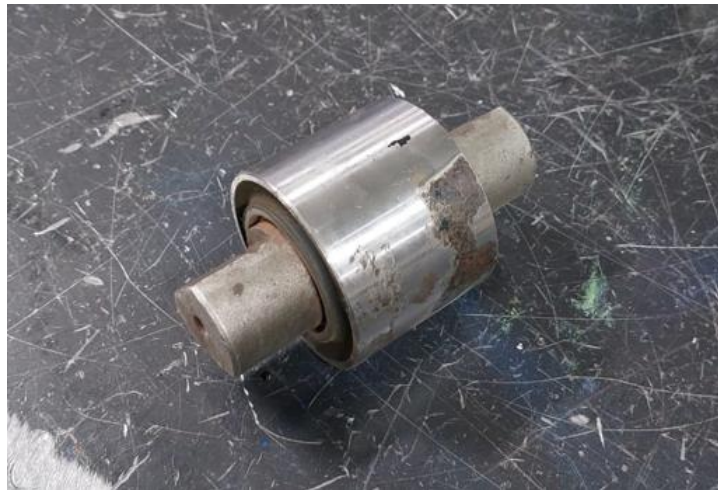
Şekil 2.1 Raylı taşıt bojisi bağlantı burcu
