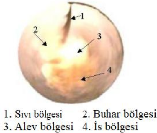
Resim 2.2 Tek delikli enjektörden püskürtülen yakıtın tutuşma anı (Kocabaş 2007).
