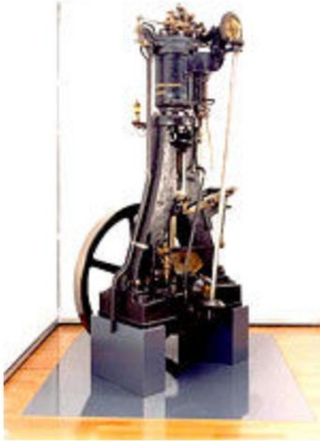
Resim 2.1 MAN tarafından retilen ilk dizel motoru (KocabaŖ 2007).
