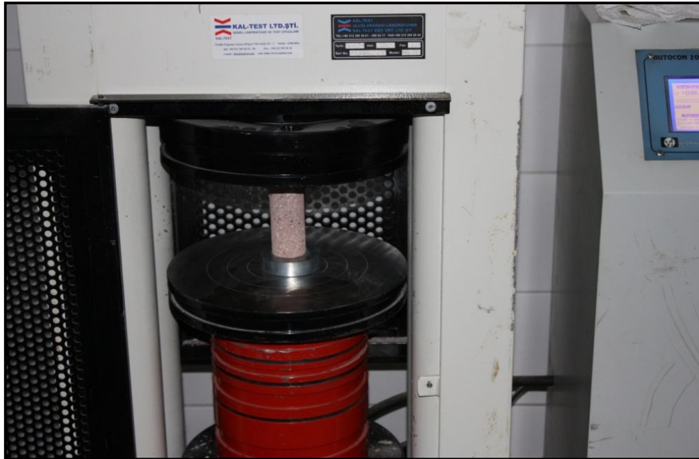
Şekil 3.8 Tek eksenli basınç dayanımı deneyinin yapılışı
