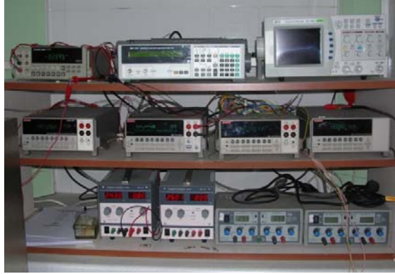
Şekil 2.9. Bilgisayar kontrollü elektriksel iletkenlik ölçüm sistemi: a. Ölçüm cihazları, b. Özel tasarım alümina iletkenlik ölçüm kiti.
