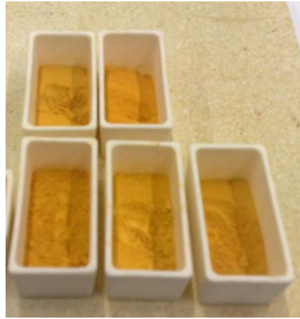
Şekil 2.4. Yüksek sıcaklığa dayanıklı özel üretilmiş alümina dikdörtgen krozeler.
