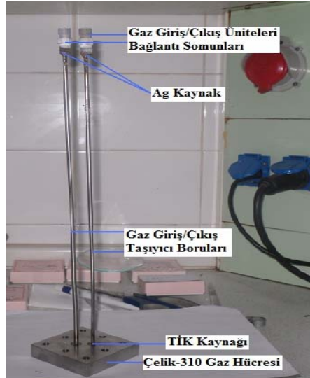
Şekil 2.20. Çelik-310'dan üretilmiş gaz besleme hücresinin arka yüzey görüntüsü.
