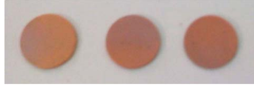
Şekil 2.8. Manuel hidrolik pres makinesi ve paletlendikten sonra sinterlenmiş bazı katı elektrolitlerin görüntüleri.
