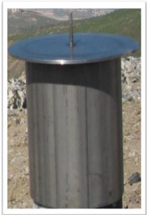
Şekil 6.26. Deponi gazı ölçümleri için imal edilen aparat.
