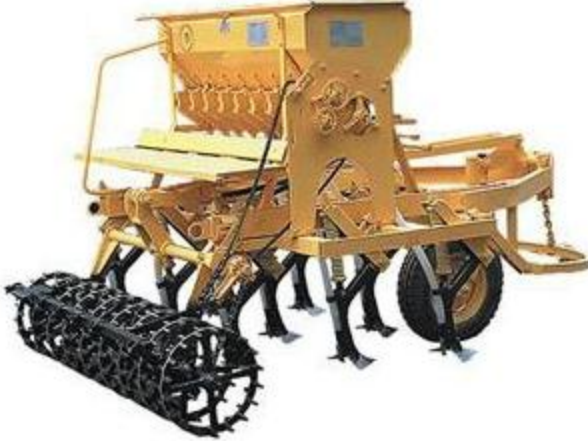
Şekil 4.16 CKII-2.1 markalı kombine ekim makinası.
