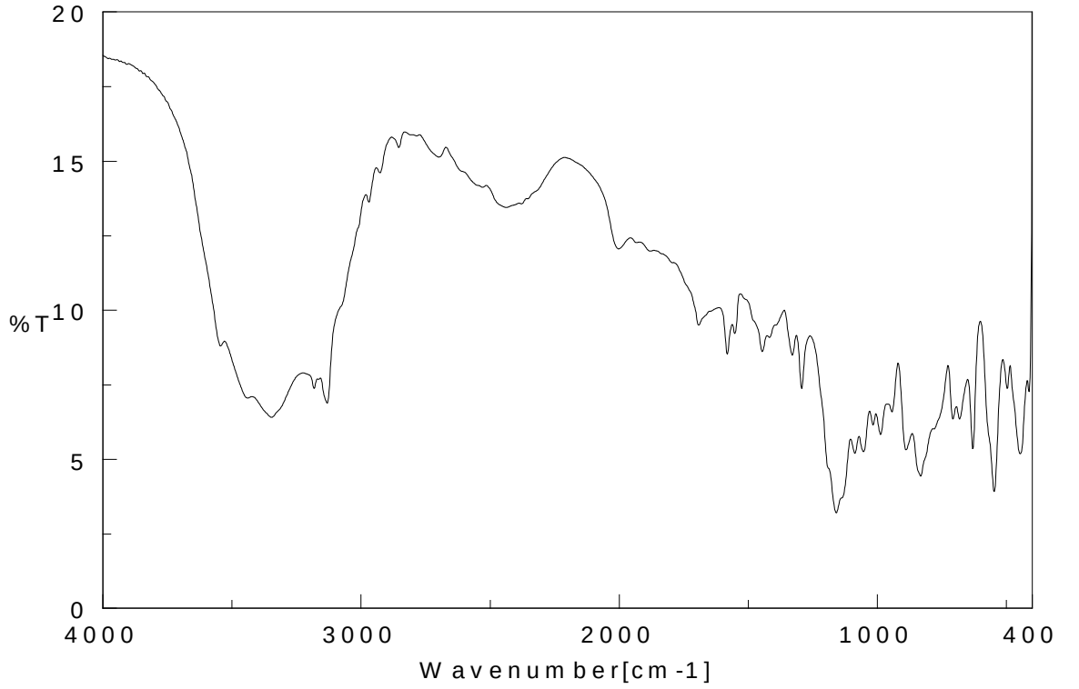
Şekil 12 : Zoledronik Asit'e ait FT-IR Spektrumu.
