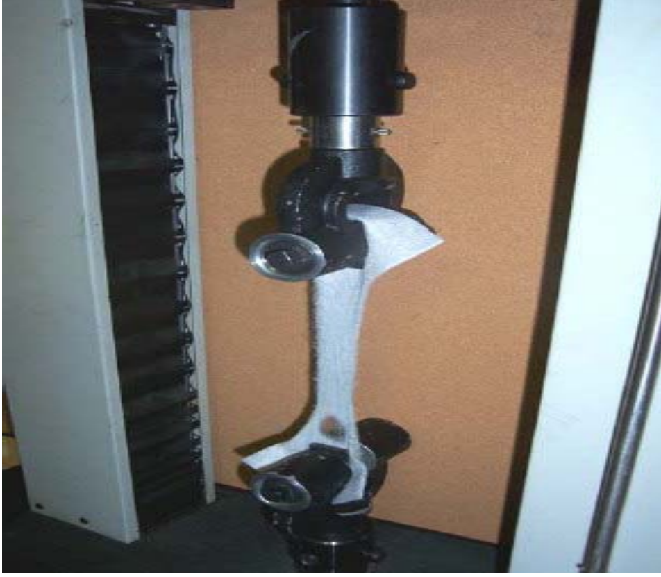
Şekil 3.9. Düz Yırtılma Deneyi
