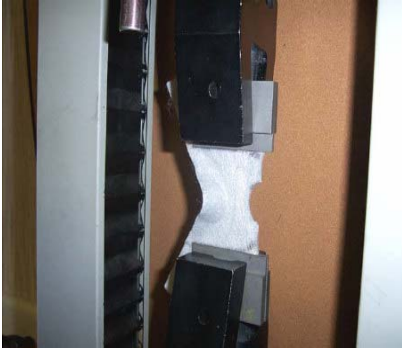
Şekil 3.8. İkizkenar Yamuk Yırtılma Deneyi
