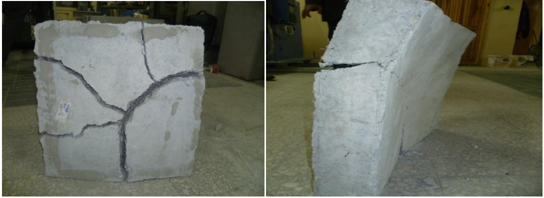
Resim 4.3. Lifli betonların kırılma modelleri
