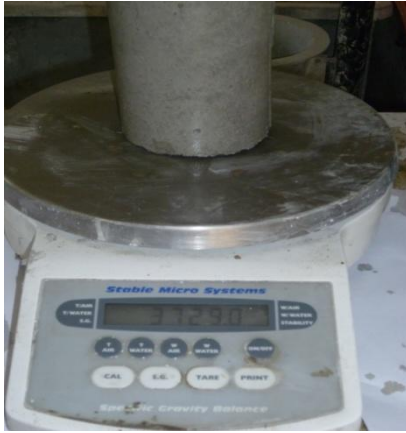
Resim 3.3. Numunenin havadaki kütlenin ölçülmesi
