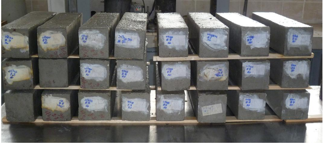
Resim 3.12. Karbonatlaşmaya bekletilen betonlar
