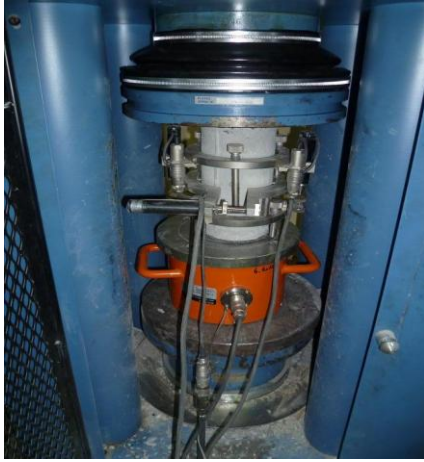
Resim 3.9. Basınç makinesinde statik elastisite modülü deneğinin yapılışı
