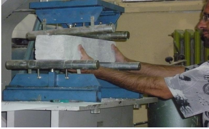
Resim 3.6. numunelerin eğilme presindeki görüntüsü
