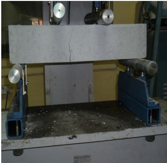
Resim 4.1. Çelik lifli betonun kırılması
