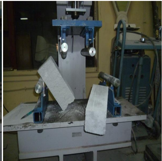
Resim 4.2. Çelik lifsiz betonun kırılması
