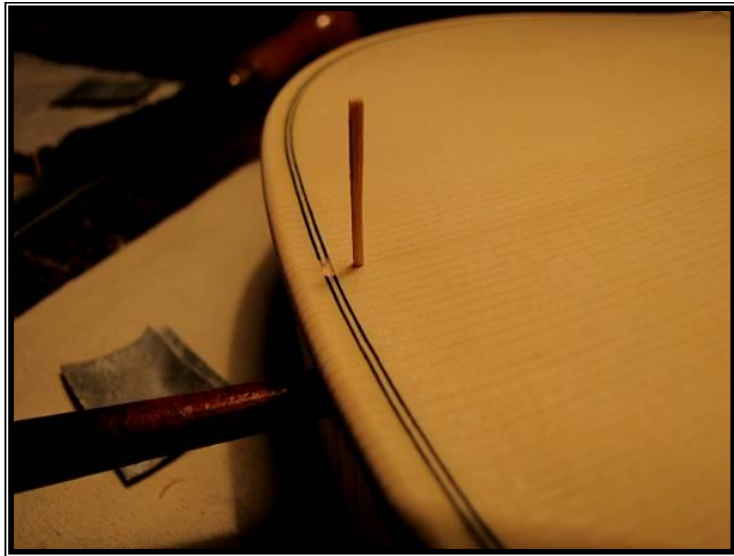
Fotoğraf 156 Çivi boşluklarının doldurulması aşamasından bir görünüm. 628
