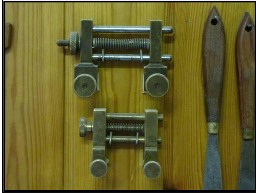
Fotoğraf 200 Çatlak onarım aparatları. 678
