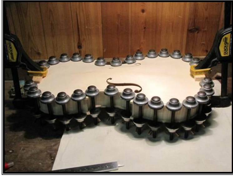
Fotoğraf 155 Üst tablanın yapıştırılması aşamasından bir görünüm. 627
