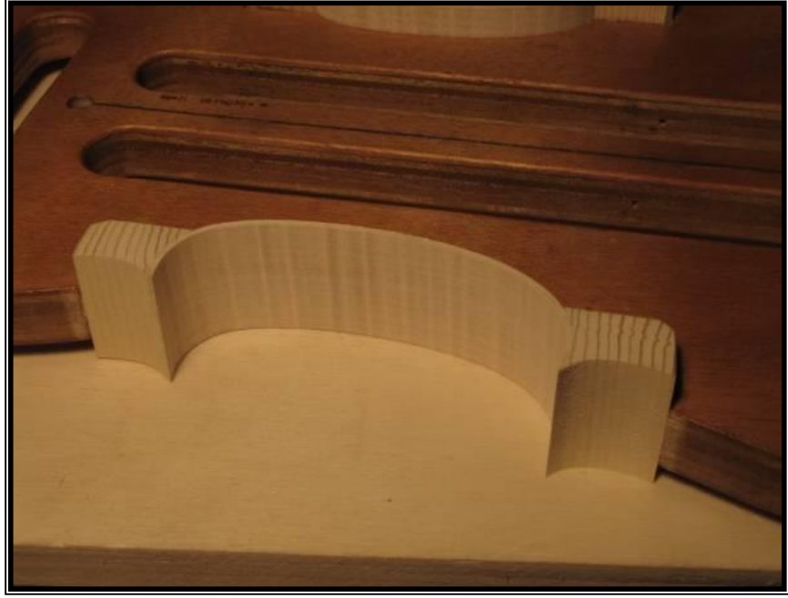
Fotoğraf 145 Tokozların tesviyesi sonrasında ‘c’ yanlıkları yapıştırılmış durumda bir görünüm. 615
