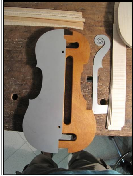
Fotoğraf 143 Keman kalıbı ve şablonların genel görünümü. 613
