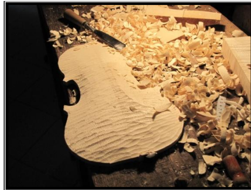
Fotoğraf 150 Üst tablanın genel bombe şeklinin kabaca ve rilmesi aşamasından bir görünüm. 621
