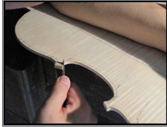
Fotoğraf 149 Tabla kenarlarının bıçakla tesviye edilmesi aşamasından bir görünüm. 620
