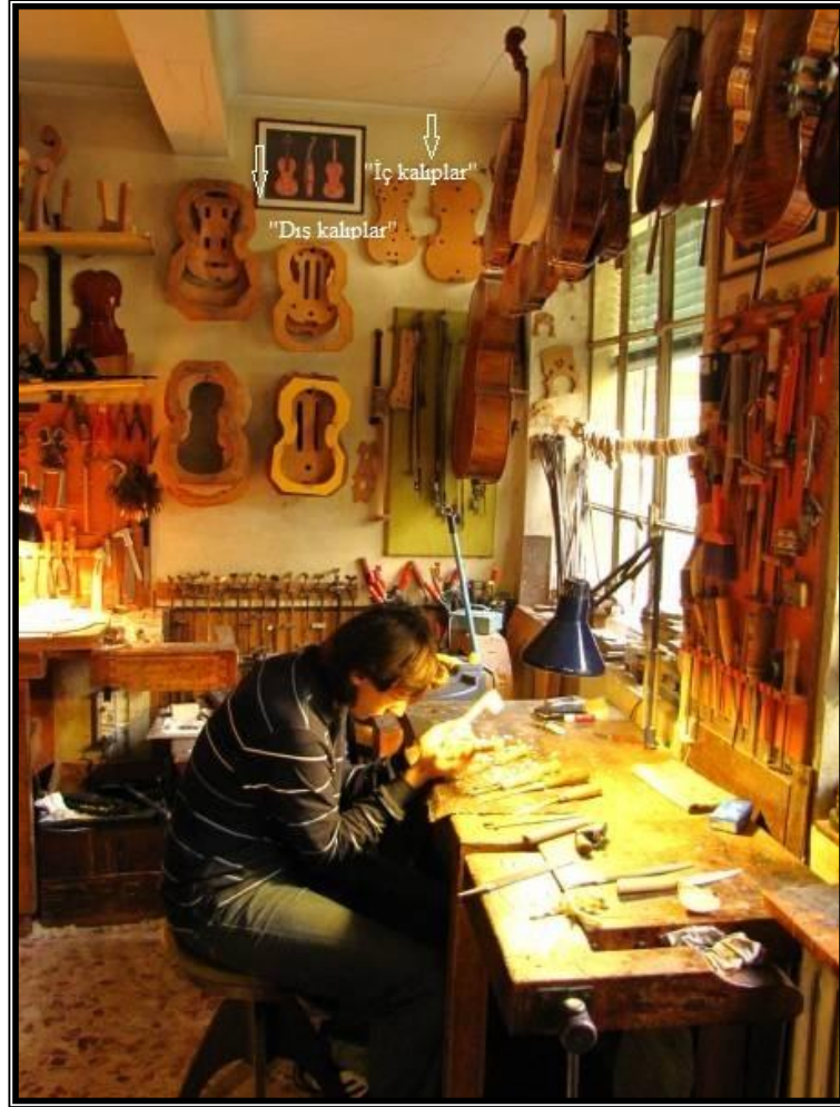
Fotoğraf 142 Stefano Conia atölyesinde görülen iç ve dış kalıplar. 612
