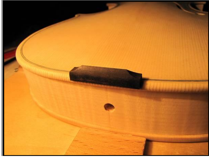
Fotoğraf 157 Alt eşiğin yapım aşamasından bir görünüm. 629
