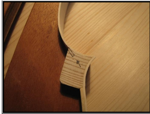
Fotoğraf 147 Mukavemet çıtasının geçki şekli. 617
