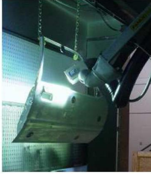
Şekil II.29. Otomotiv Endüstrisinde UV Işınlarıyla Sertleşebilen Robotik Kaplama Uygulaması [67]
