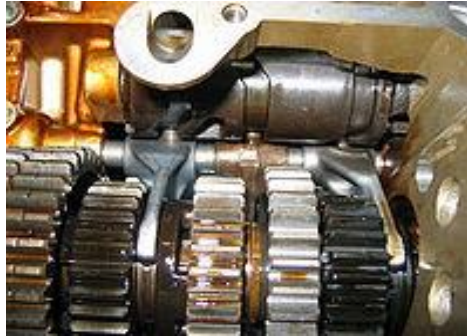
Şekil II.12. Bir Dişli Kutusu Ve Dişli Çarklarının Yağlanması [7]
