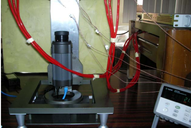
Resim 3.11. Termal kameranın deney sistemindeki bağlantısının görünüşü
