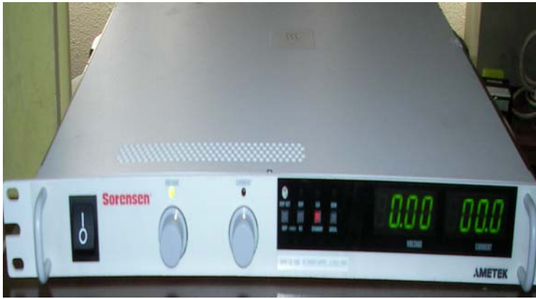
Resim 3.9. Yüksek akım sağlayan DC güç kaynağı
