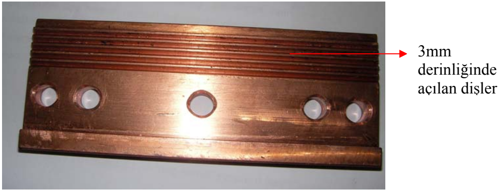
Resim 3.7. Bakır pabuç ve üzerine açılan dişler
