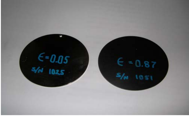
Resim 3.2. AE model emisometre kalibrasyon numuneleri
