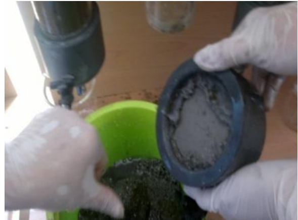
Şekil 4.2 a) Kinetik kolon düzeneklerinin görünümü, b) filtre ızgaralarında önce kullanılan cam yünü ve yerini alan akrilik yün malzemelerinin görünümü, c) kolon filtre haznesi.
