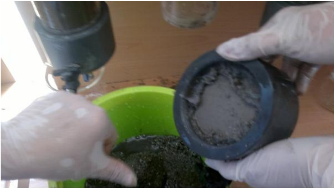
Şekil 5.11 Bozunma süreçlerine maruz bırakılan kolonlardan kimyasal analizleri ve mineral bozunmasını belirlemek için örnek alımı.
