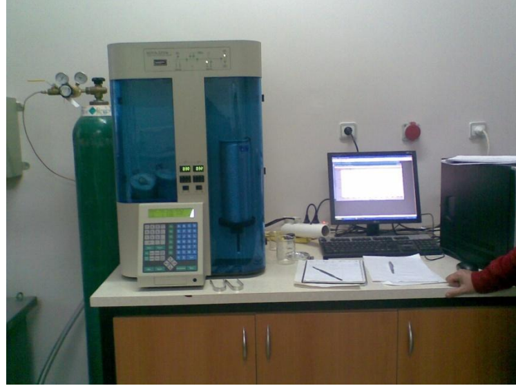
Şekil 5.2 Örneklerin yüzey alanı ve mikro gözeneklilik belirlenmesinde kullanılan “yüzey alanı ve gözenek boyu analiz cihazı” görünümü.
