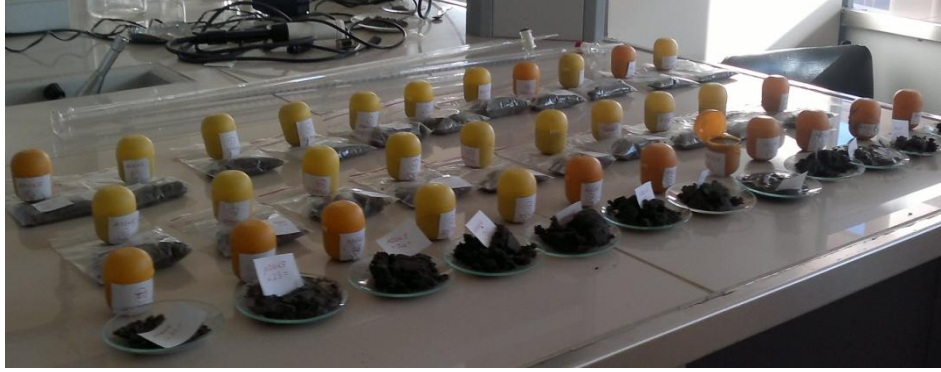
Şekil 5.7 Mineralojik bileşim ve bozunma sonrası örneklerde meydana gelen değişim belirlenmesi amacıyla kolonlardan periyodik örnek alımı.
