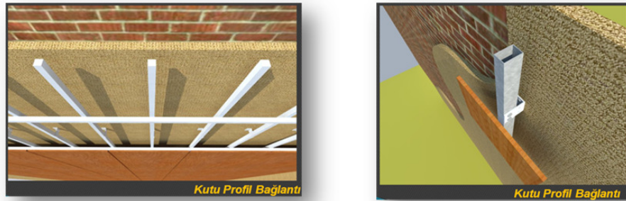
Şekil 3.28. Fibercement fugalı levha uygulama detayı [3].
