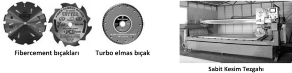
Şekil : 3.25. Fibercement kesim bıçakları, testere ve sabit kesim tezgahı [19].
