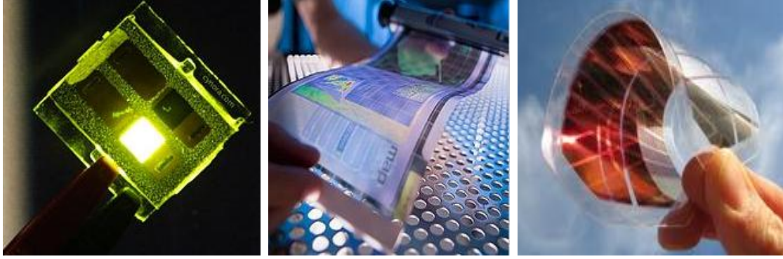
Şekil 5.1 Sırasıyla organik ışık yayan diyot(OLED), organik alan etkili transistör (OFET) ve organik fotovoltaiik hücre (OPV) gösterilmiştir.
