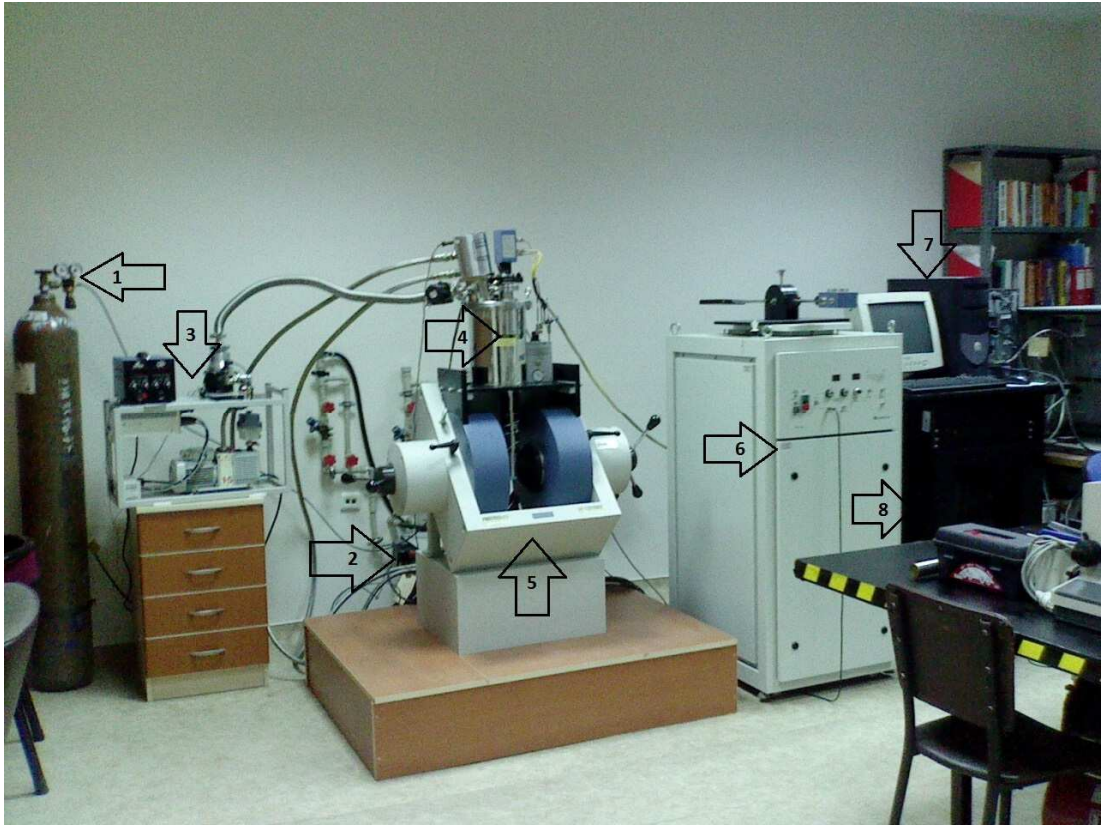
Resim 4.1. Lake Shore'un Hall etkisi ölçüm sistemi 1) Helyum tüpü, 2) Helyum kompresör, 3) Vakum pompa sistem, 4) Malzemenin konulduğu kryostat, 5) Manyetik alan uygulamak için magnet, 6) Güç kaynağı, 7) Bilgisayar, 8) Kontrol ünitesi
