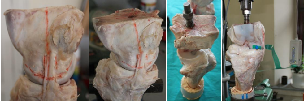
Şekil 29. Femur proksimaline özel yapım vidanın yollanması ve deney düzeneği içerisindeki görüntüsü.
