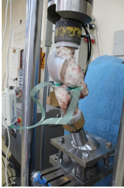
Şekil 26. Ön deneylerde kullanılan örnekler (sol tarafta her iki kompartman korunan ve sağ tarafta sadece medial kompartıman korunduğu örnekler).
