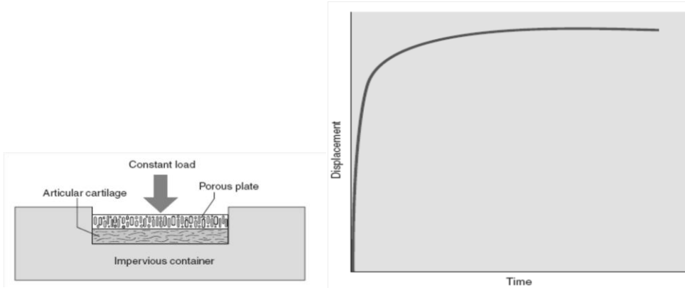
Şekil 10. Kıkırdak materyal özelliklerini ortaya koymak için yapılan kapalı kompresyon düzeneği ve sürekli yükleme altında kıkırdığın zamana bağlı deplasmanı gösteren grafik. Bu sayede kıkırdığın iki fazı da değerlendirilebilir (The mechanics and pathomechanics of human articular cartilage-Chapter 5:Biomechanics of the cartilage - JM Mansour,2003).
