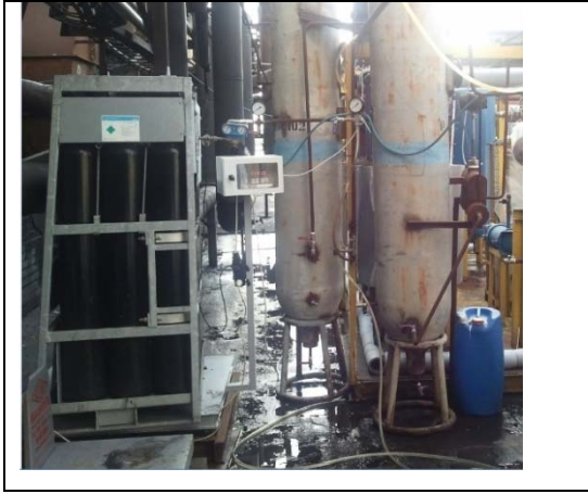
Resim 3.5. Pilot tesis ekipmanları ( \text{CO}_2 tüp ünitesi ve terazi)
