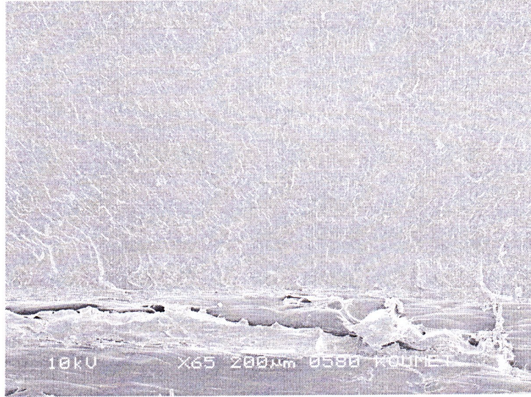
Şekil 3.43. PHK natürel malzemeye ait SEM görüntüleri (Çentik dibi x65 büyütme)
