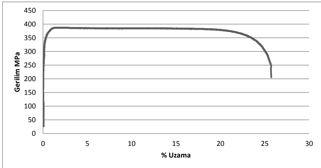
Şekil 7.6 : Borunun kaynak olmamış bölümünden alınan parçadan yapılan çekme testi.
