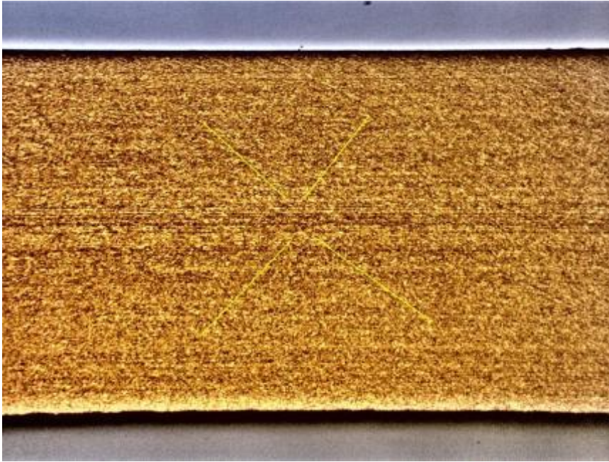
Şekil 4.7 : H400LA kalite 1.5 mm et kalınlığındaki bandın metalografik muayenesinde görülen segregasyon bandı.
