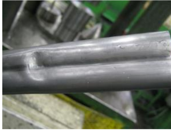
Şekil 7.12 : 3 numaralı numunede saat 12 yönünde göçme.
