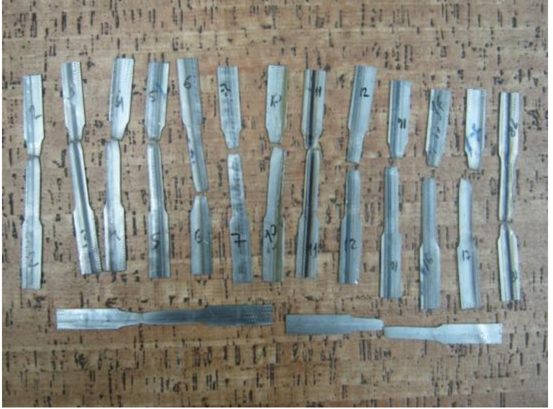
Şekil 7.8 : Kaynak pozisyonu çekme yönünde çekme testi yapılmış numuneler.
