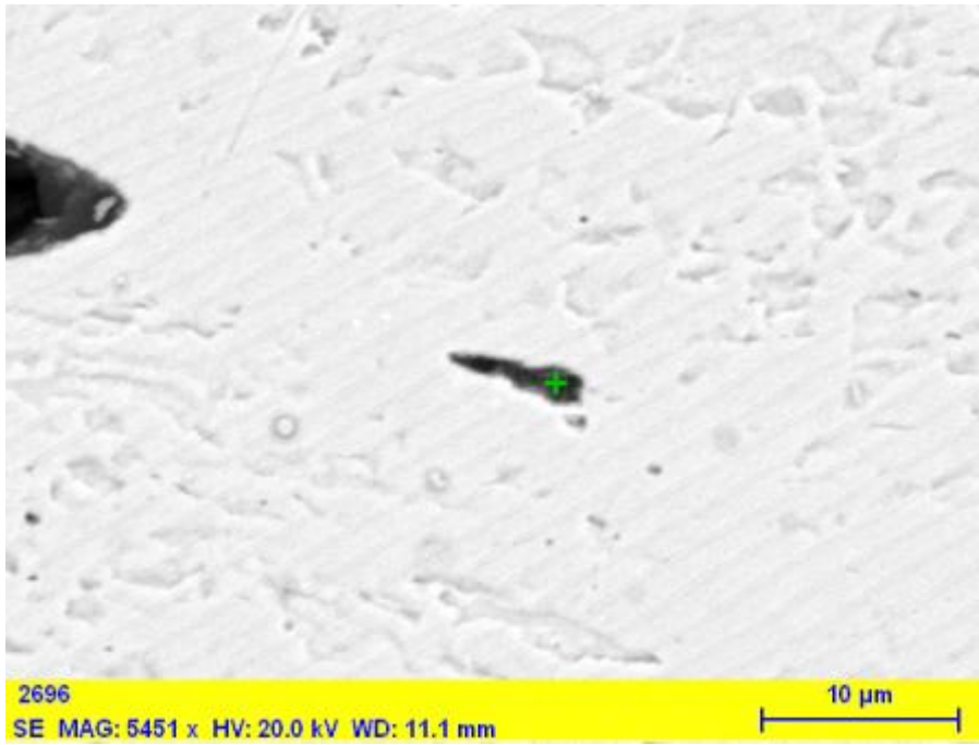
Şekil A.6 : Çatlağın devamında görünen hata.
