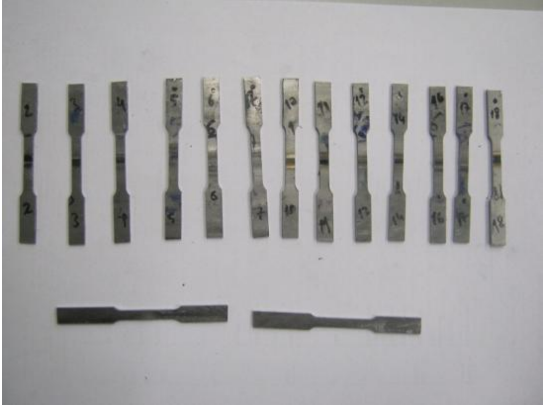
Şekil 6.10 : ASTM E8 'e göre kaynak pozisyonu çekme yönüne dik olacak şekilde alınan numuneler.
