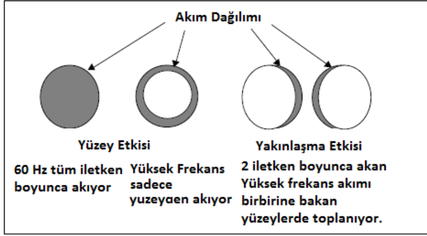
Şekil 2.2 : Yüksek frekans indüksiyon kaynağını gerçekleştiren temel 2 etken [4].
