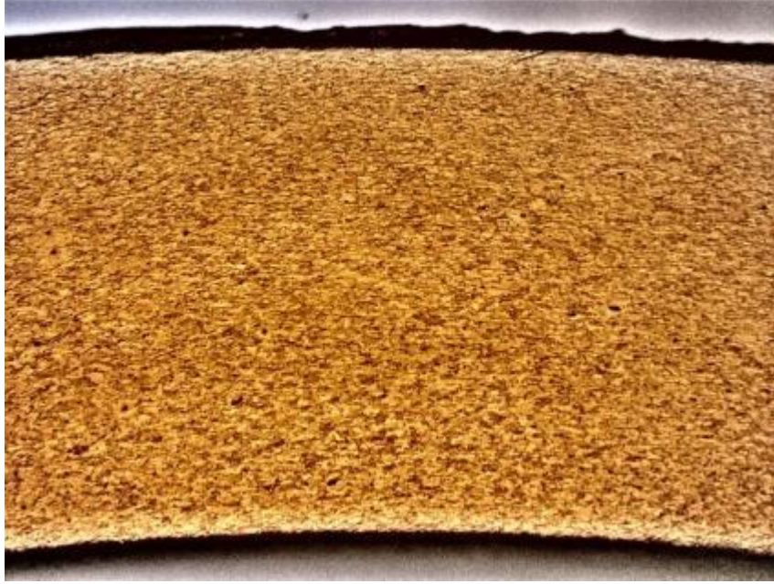
Şekil 4.8 : H320LA bandında kalite 1.5 mm et kalınlığındaki bandın metalografik muayene görüntüsü.
