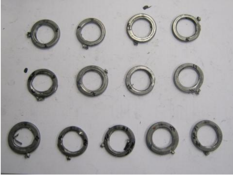
Şekil 7.17 : 13 adet numuneye uygulanan kripling işlemi sonrası numuneler.
