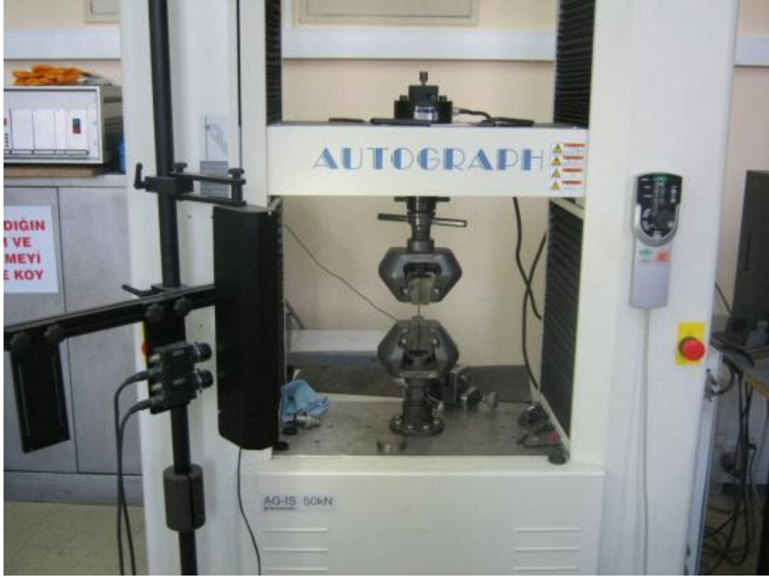
řekil 6.8 : ekme testinde kullanılan ekme test cihazı.
