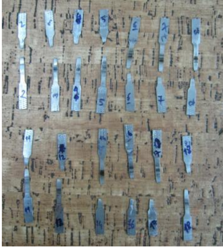
Şekil 7.7 : Kaynak pozisyonu çekme yönüne dik çekme testi yapılmış numuneler.
