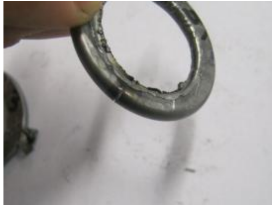
Şekil 7.18 : 4 numaralı numuneye uygulanan kripling işlemi sonrası durum.
