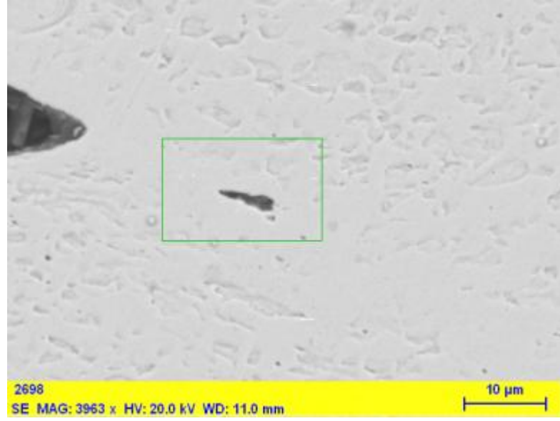
Şekil A.7 : Çatlağın devamındaki inklizyonun kimyasal analizi Mn ve S oranının yüksek çıkması Mangan ve Kükürt içeriğinin MnS olarak 7132 EDÇ bandında biriktiği bölgeden kaynaklandığını göstermektedir.
