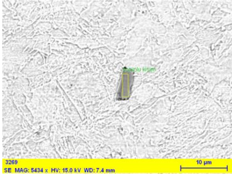
Şekil B.8 : 8 mikron çapında Ti, Nb taneleri bulunan bölge.
