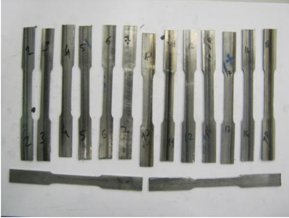
Şekil 6.12 : ASTM E8 ‘e göre kaynak pozisyonu çekme yönünde olacak şekilde alınan numuneler.
