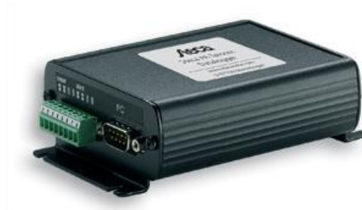
Şekil 3.22. Elektriksel verilerin alımı için kullanılan veri kaydedici (Anonim, 2011b)
