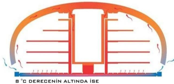
Şekil 4.18 Sıcaklık 8 °C Derecenin Altında İse Binanın Tepkisi (Foster, Kiem, Buchanan, 2011)
