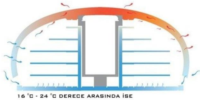
Şekil 4.20 Sıcaklık 16 °C-24 °C Dereceleri Arasında İse Binanın Tepkisi (Foster, Kiem, Buchanan, 2011)
