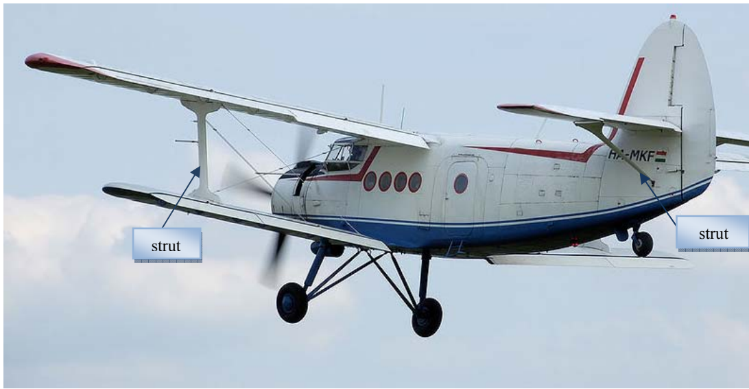
Şekil 1.1 : Antonov An-2 uçağı ve üzerindeki strutlar [13].
