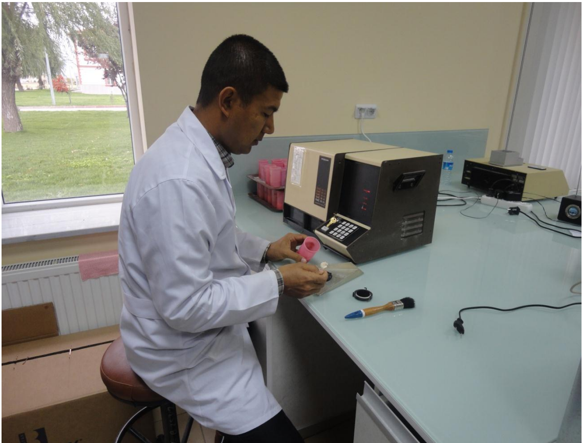
Ek-16 NIR (Near Infra Red) cihazında protein, kuru gluten ve nem tayini
