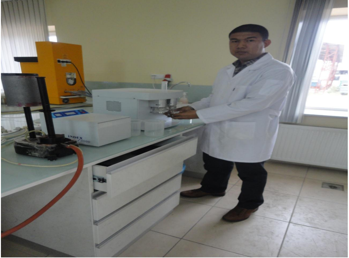
Ek-17 Glutomatik cihazında yaş gluten tayini
