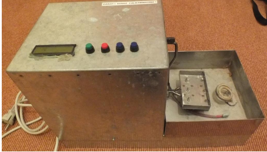
Resim 2.6. Abrasyon oluşturmak için kullanılan fırçalama cihazı
