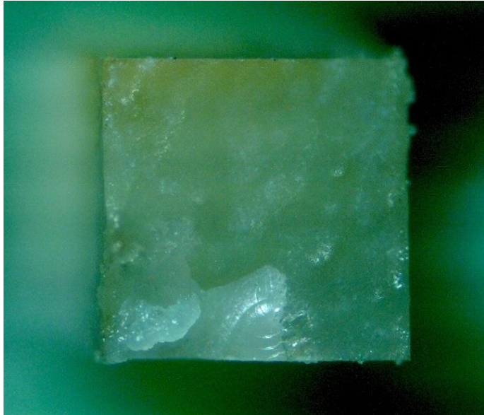
Resim 3.6: Karışık tip kırılmanın kompozit yüzeyi
