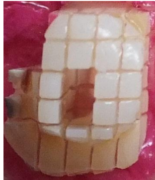
Resim 2.16.Mikrogerilim testi iin ubukların hazırlanması.
