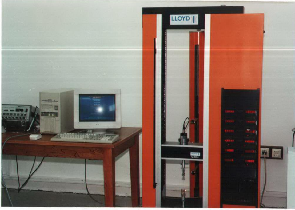
Şekil 31: 486DX/50 bilgisayarına bağlı Lloyd M30K Materyal Germe Test Makinası.
