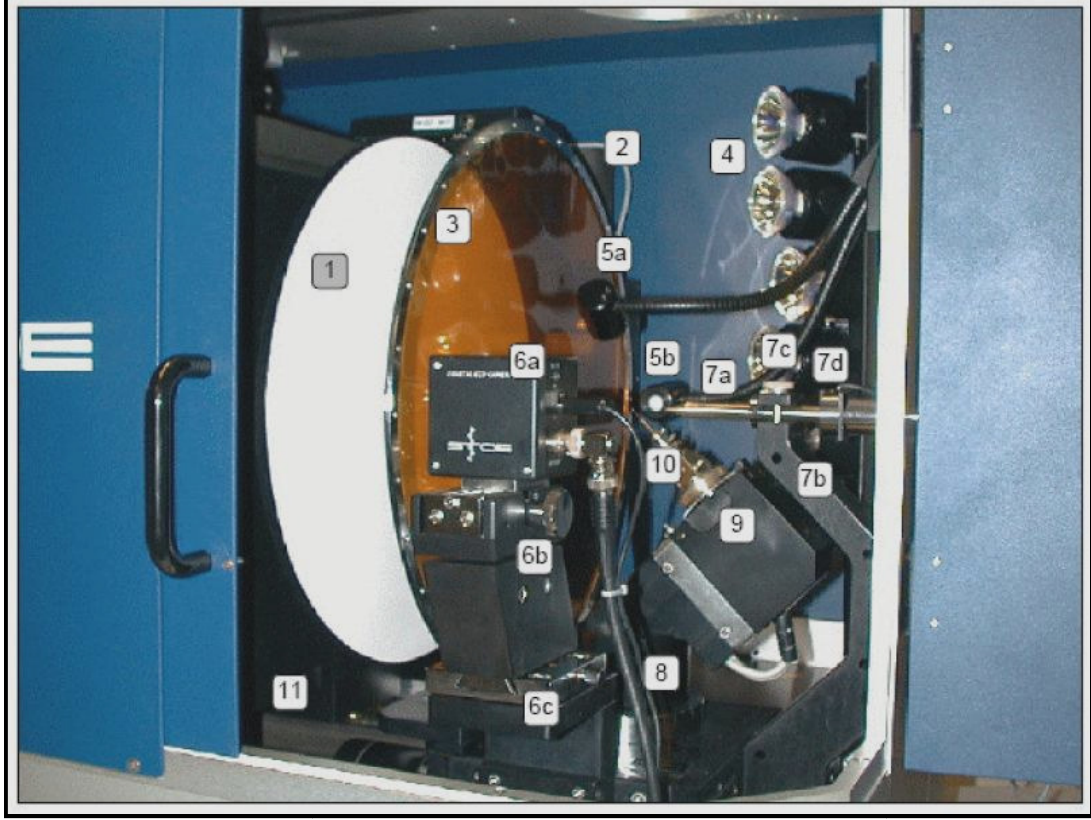
Şekil 2.1. STOE IPDS II difraktometresine ait iç kısım ayrıntıları: 1) Görüntüleme plakası, 2) Okuyucu başlık, 3) Ana ışın tutucu, 4) Silici ışıklar, 5a) ve 5b) Numune aydınlatma lambaları, 6a) Video kamera, 6b) Optik kısım, 6c) Video kamera tutucu, 7a) Kolimatör, 7b) Kolimatör tutucu, 7c) Kolimatör vidası, 7d) Güvenlik düğmesi, 8) Omega ( \omega ) dönü eksen, 9) Phi ( \phi ) eksen-numuneyi döndüren eğik eksen, 10) Gonyometre başlığı, 11) Görüntüleme plakası taşıyıcı.
