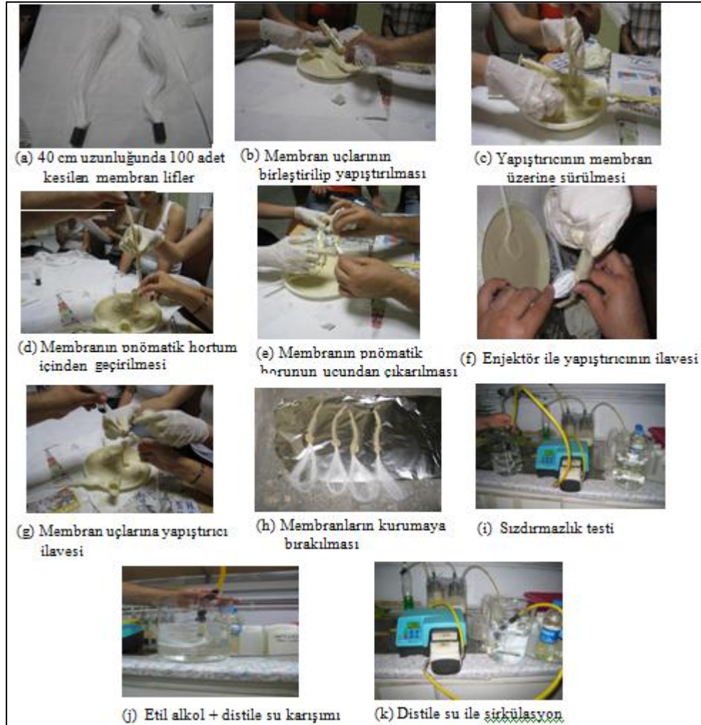
Şekil 3.6: Membran yapımı adımları.
