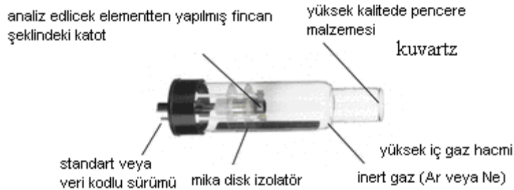
Şekil 2.2. Oyuk Katot Lambası [125]
