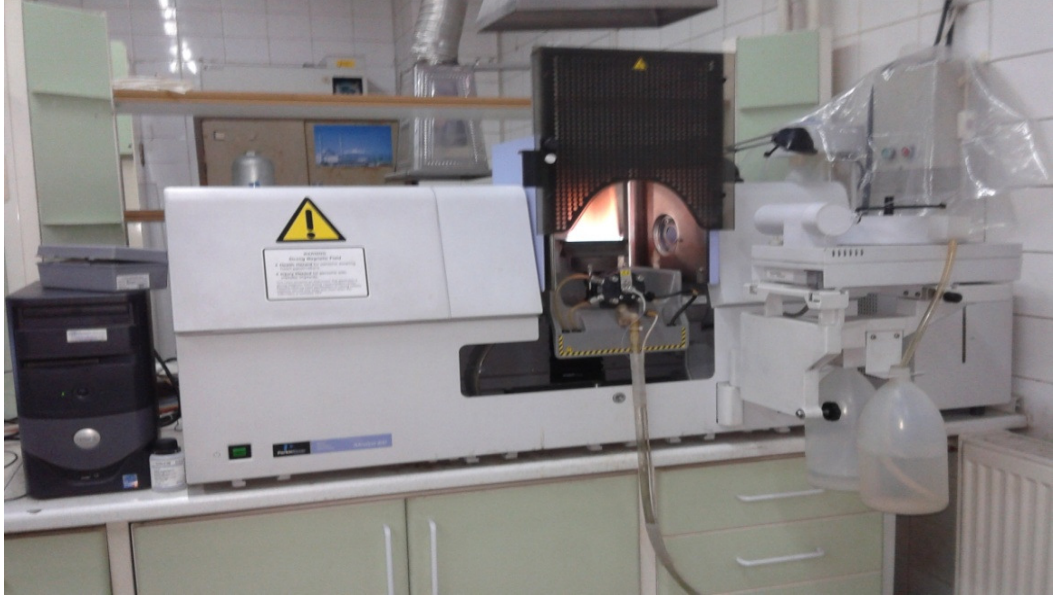
Şekil 3.1. PerkinElmer Marka AAnalyst 800 model alevli atomik absorpsiyon spektrometresi
