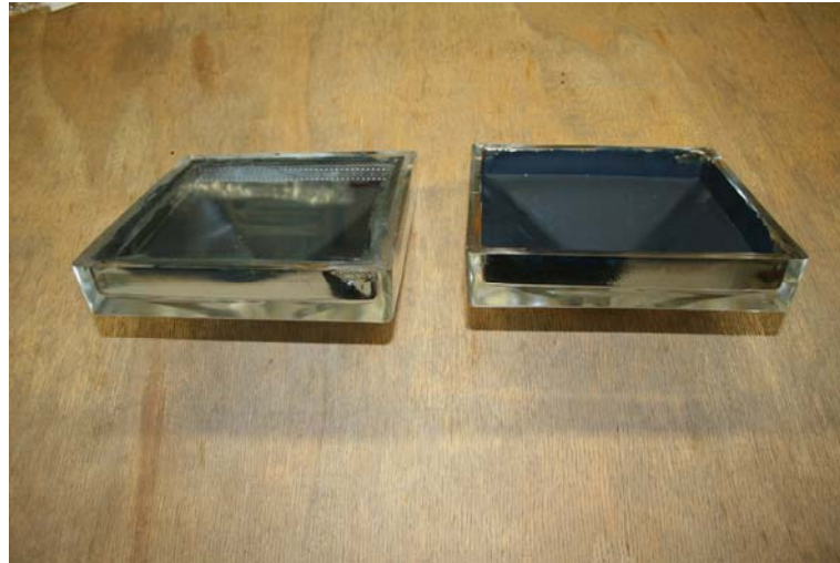
Şekil 4.15 : Cam blok malzemenin iç yüzeyinde ısı cam uygulanmış (solda) ve uygulanmamış mevcut cephedeki durum (sağda).
