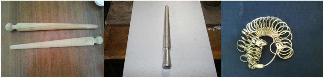
Şekil 4.12 Malafa(tahta, metal) ve yüzük ölçü aleti
