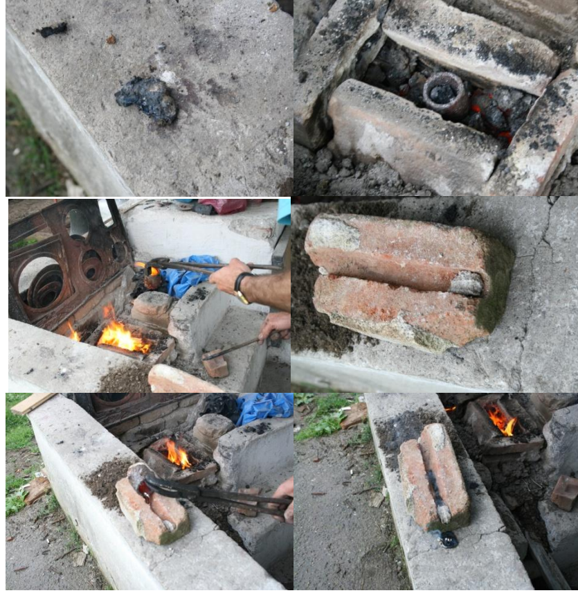
Şekil 4.32 Savatın ikinci kez yakılması ve şiddeye dökülmesi
