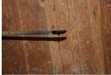
Şekil 4.28 Demir çubukla savatın karıştırılması
