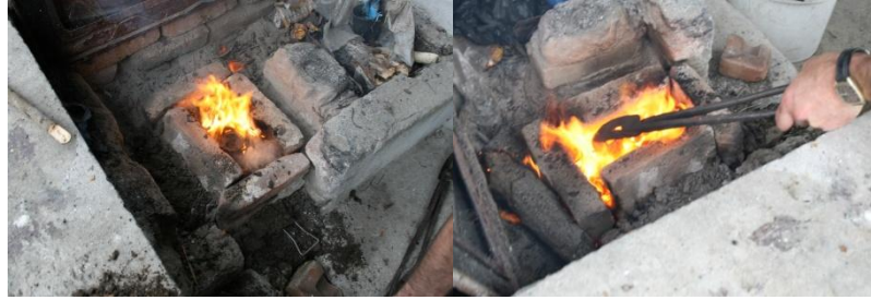
Şekil 4.26 Eritme ocağının hazırlanması
