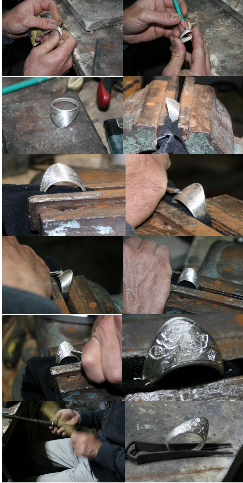
Şekil 4. 36 Gümüş yüzeyde çelik kalemlerle desenin çizilmesi ve oyulması işlemleri
