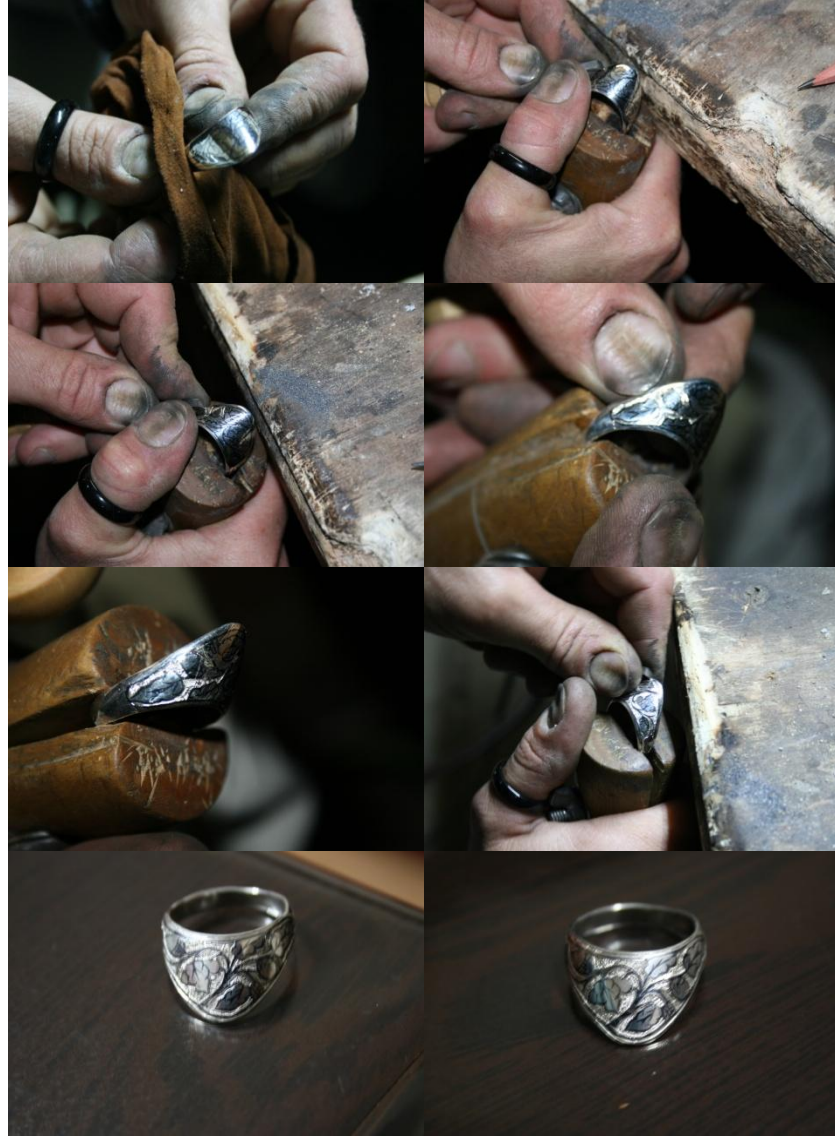
Şekil 4.43 ince uçlu kalemlerle yüzeyde tarama ve tırtık yapılması
