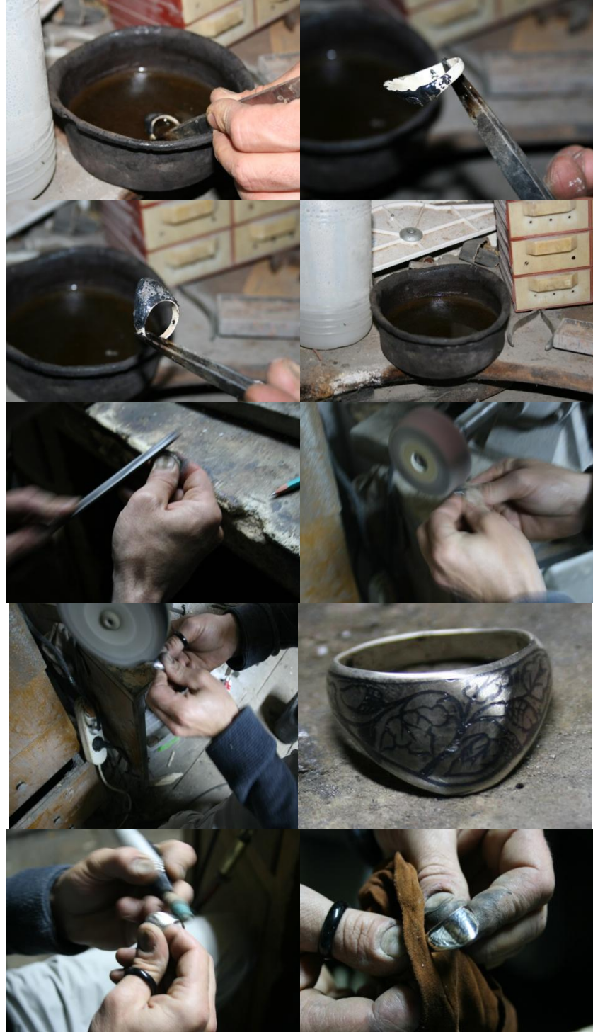
Şekil 4.39 Savatlı yüzüğün asite atılması ve parlatma işlemleri
