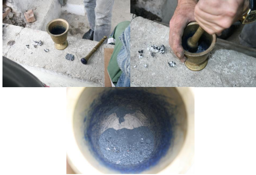
 ekil 4.34 Savatın ezilerek hazırlanması
