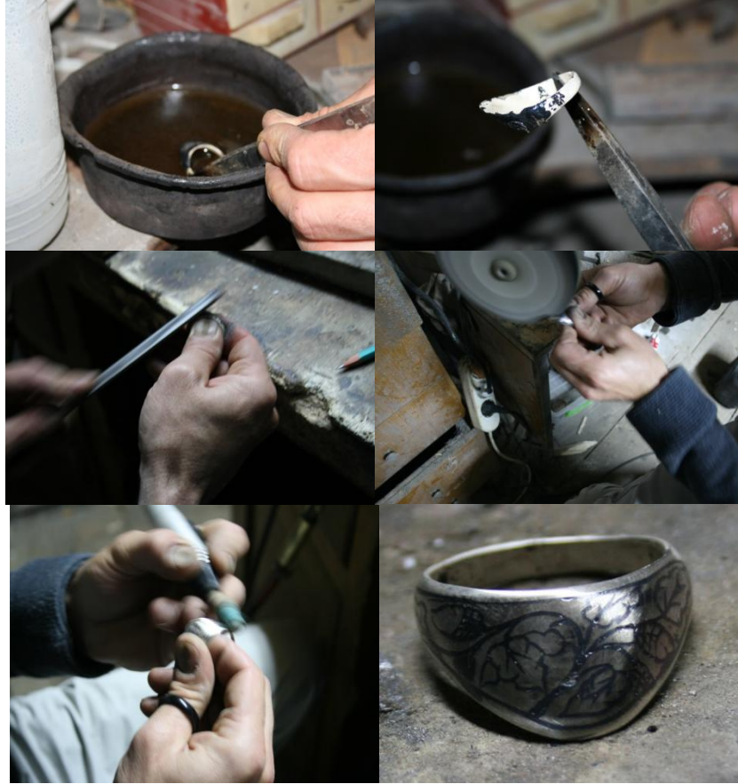
Şekil 4.41 Yüzüğün asite batırılması ve parlatma işlemi
