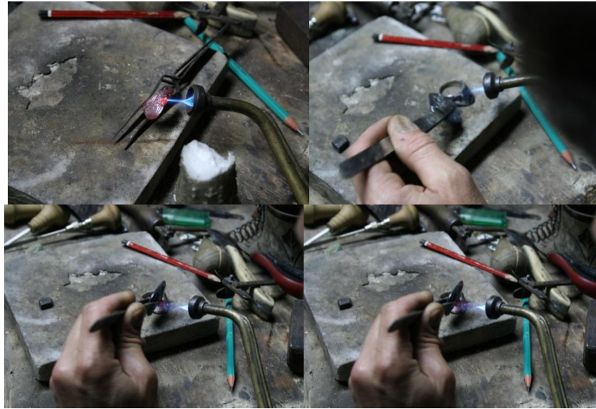
Şekil 4.37 Çubuk haldeki savatın yüzeye uygulanması
