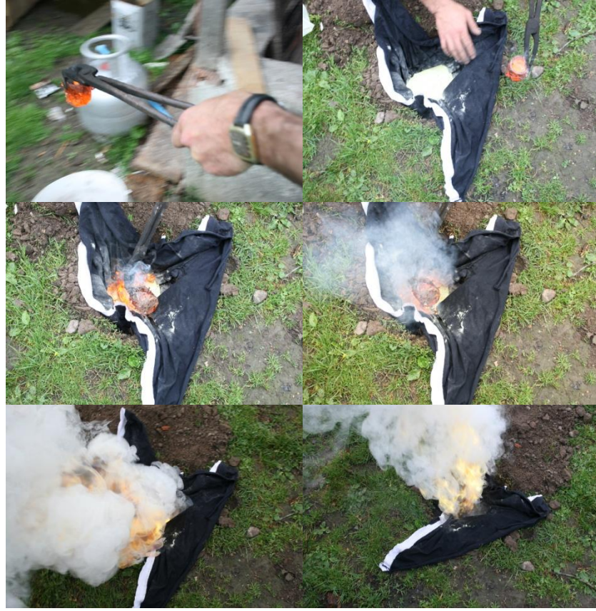
Şekil 4.29 Potadaki alaşımın kükürt çukuruna dökülmesi ve yakılması
