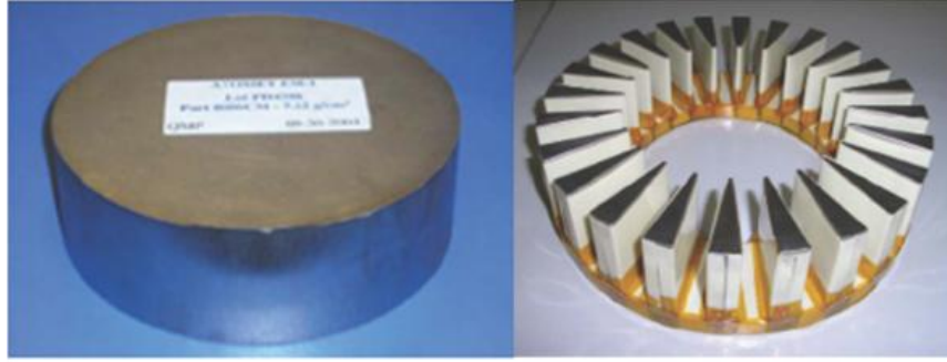
Şekil II.6 a)SMC malzeme, b)SMC’den elde edilen stator[54].
