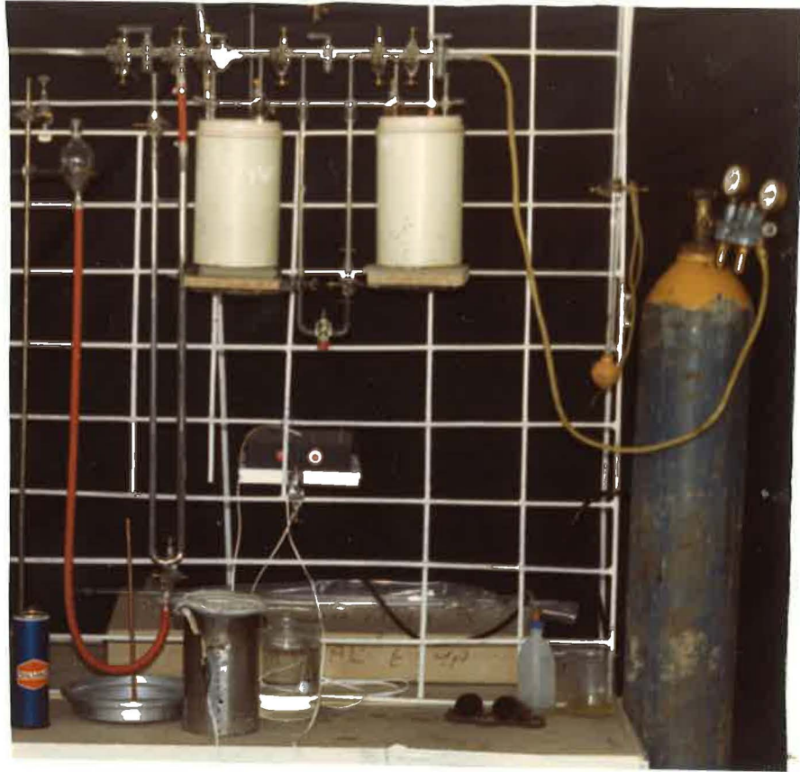
Resim.6.1.B.E.T. Tek Nokta Adsorpsiyonu Deney Düzeneği
