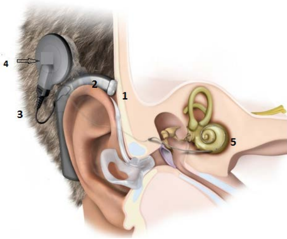
Şekil 1.2: Koklear implant sistemi: 1.mikrofon, 2.konuşma işlemcisi, 3.kablo, 4.iletici bobin, 5..intrakoklear elektrot.
