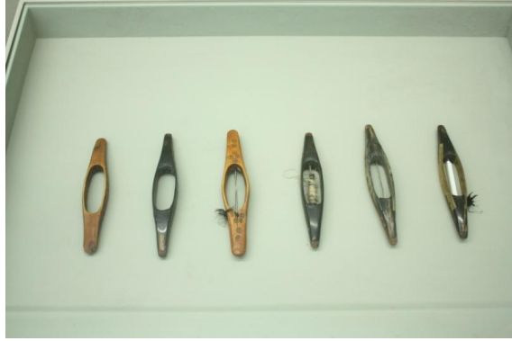
Resim 3.16. Eham Dokumak İçin Kullanılan Eham Mekiği, Öküz Boynuzundan Ve Ahşaptan Olmak Üzere 6 Adet Bulunmaktadır
