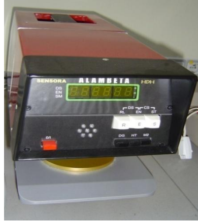
Şekil 3.12: Alambeta test cihazı
