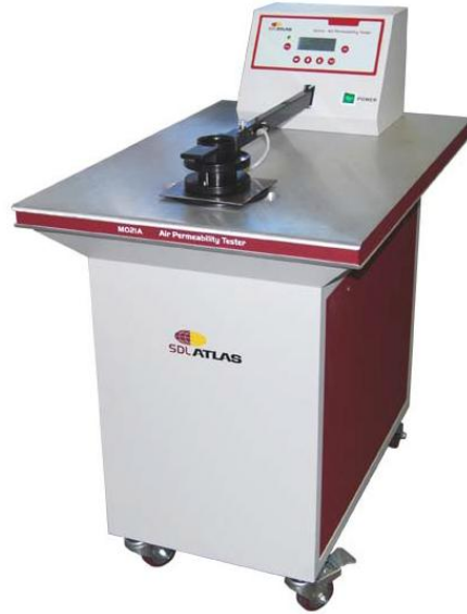
Şekil 3.10: SDL Atlas M021A Hava geçirgenliği test cihazı
