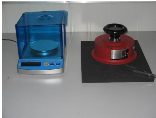
Şekil 3.13: Hassas terazi ve 100 cm 2 ’lik kumaş şablonu
