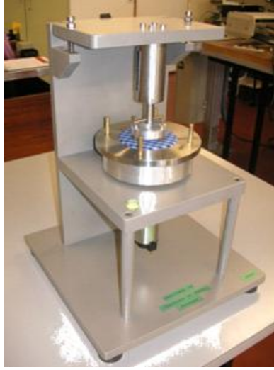
Şekil 3.15: Frictorq sürtünme katsayısı test cihazı
