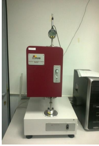
Şekil 3.16: SDL Atlas dijital sertlik ölçer test cihazı
