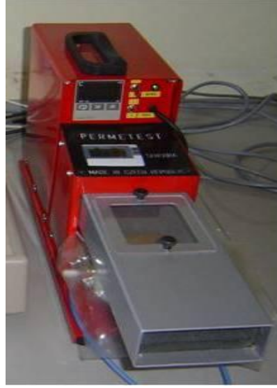
Şekil 3.11: Permetest Su buharı geçirgenliği test cihazı
