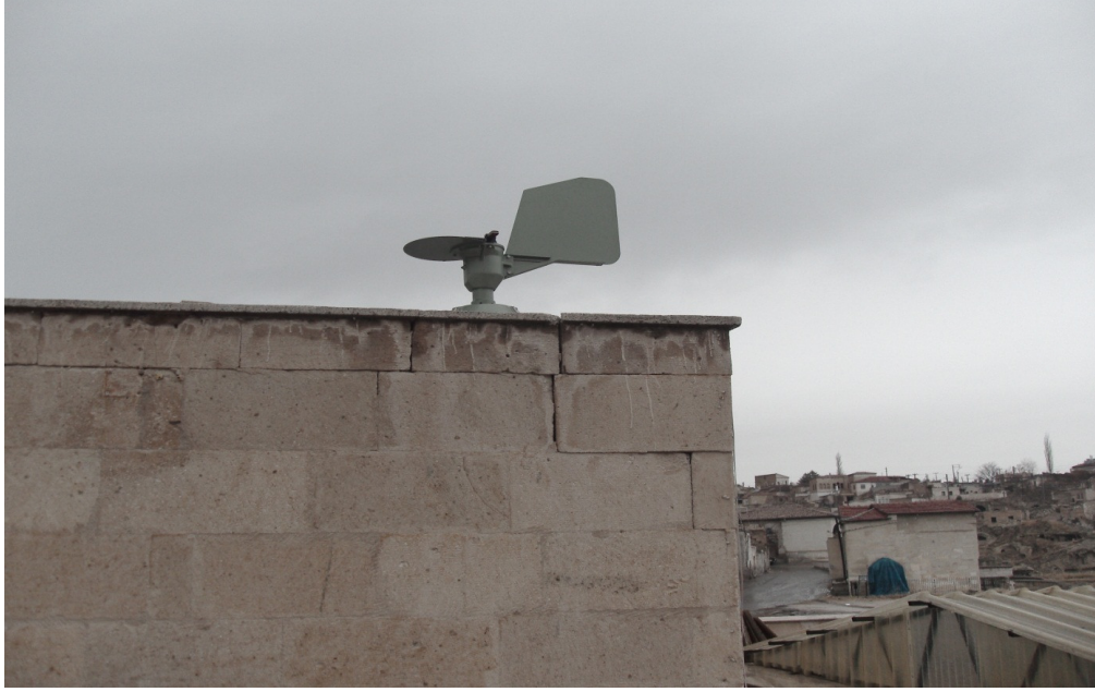
Şekil 3.3. Burkard aleti ve yerleştirildiği Kapadokya Meslek Yüksek Okulunun çatısı
