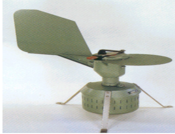
Şekil 3.1. Burkard polen ve spor tuzaklama aracının genel görünüşü.
