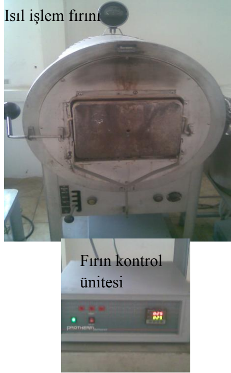
Resim 4.8. Östempirleme ısıtım fırını ve tuz banyosu düzeneđi
