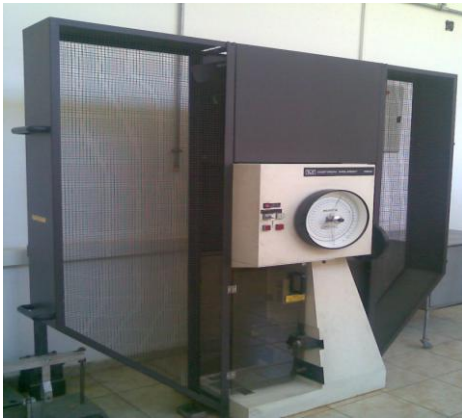
Resim 4.13. Darbe Testi Cihazı
