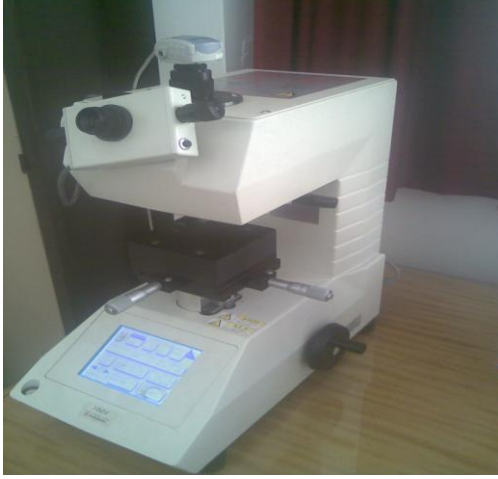
Resim 4.12. Sertlik ölçüm cihazı (HVM)
