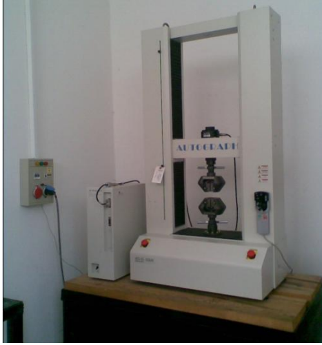
Resim 4. 14 Çekme Testi Cihazı
