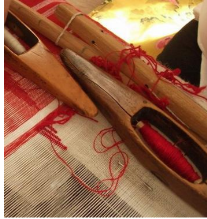
Şekil 4.10. İçinde Masura Bulunan Mekik.
