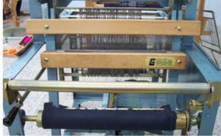
Şekil 4.34. Tarak, Tefe, Kumaş Köprüsü ve Kumaş Levendi.
