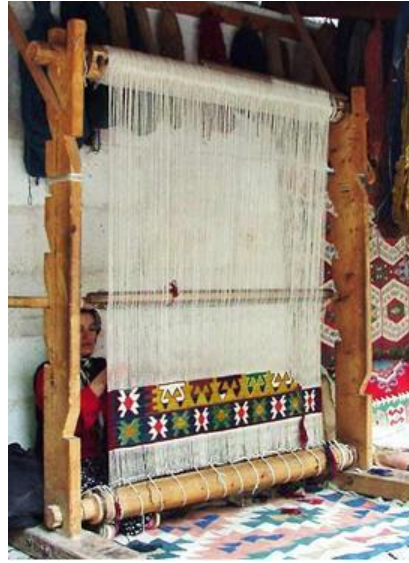
Şekil 3.5. Ahşap Dokuma Tezgâhı.
