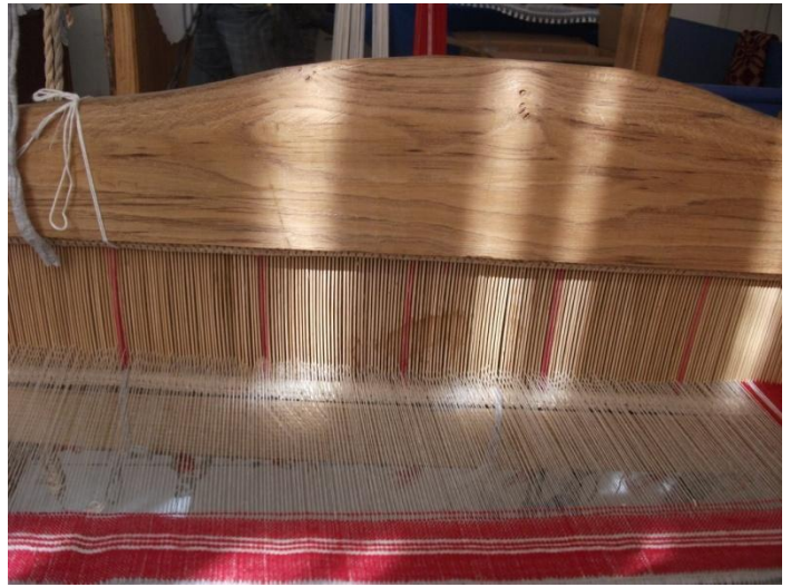
Şekil 4.15. Tarak ve Dupa.
