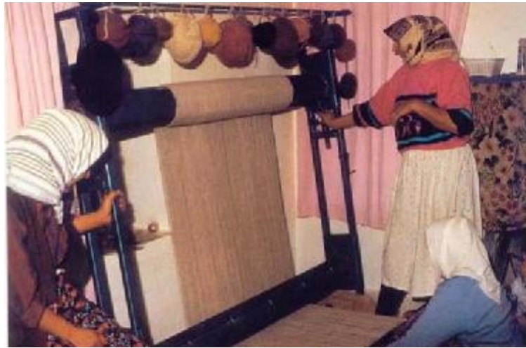
Şekil 3.14. Çözgülerin Tezgâha Takılması.
