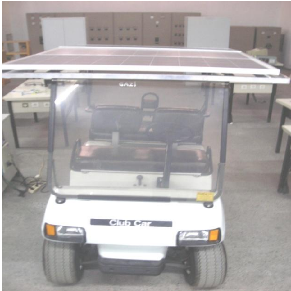
Resim 3.1. Güneş pilleri ile donatılmış aracın fotoğrafı
