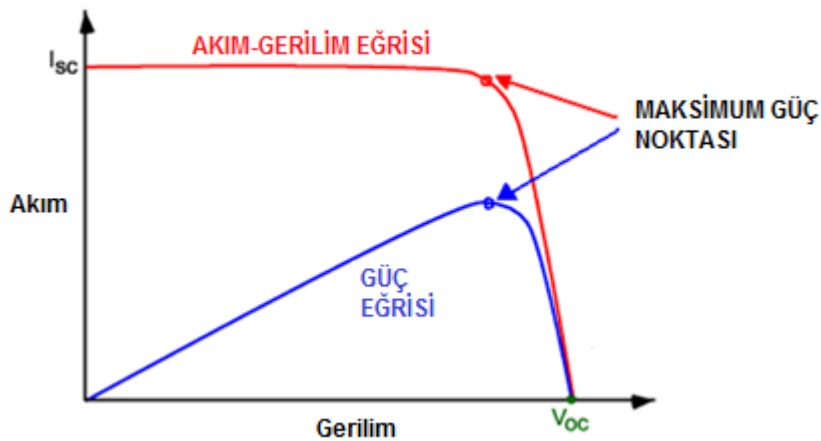
Şekil 2.3. Güneş pilinin akım-gerilim ve güç karakteristikleri
