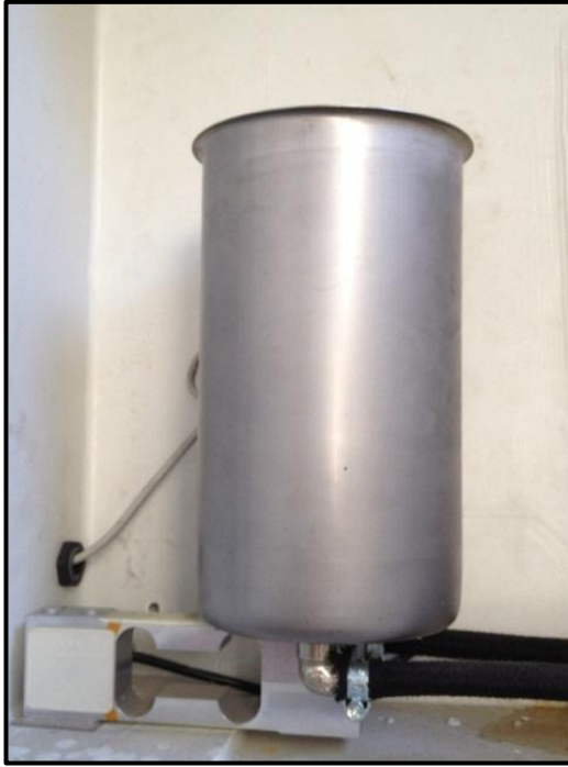
Resim 4.11. Kontrol ünitesine bağlı çalışan, yük hücreli yakıt deposu
