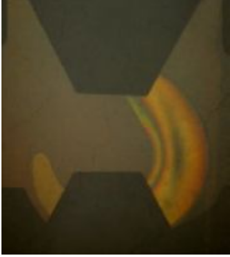
Resim 3.4. Yük kancasından fotostres görüntü resmi ve renk saçaklarının görünümü [Azeloğlu ve Alpay, 2009].
