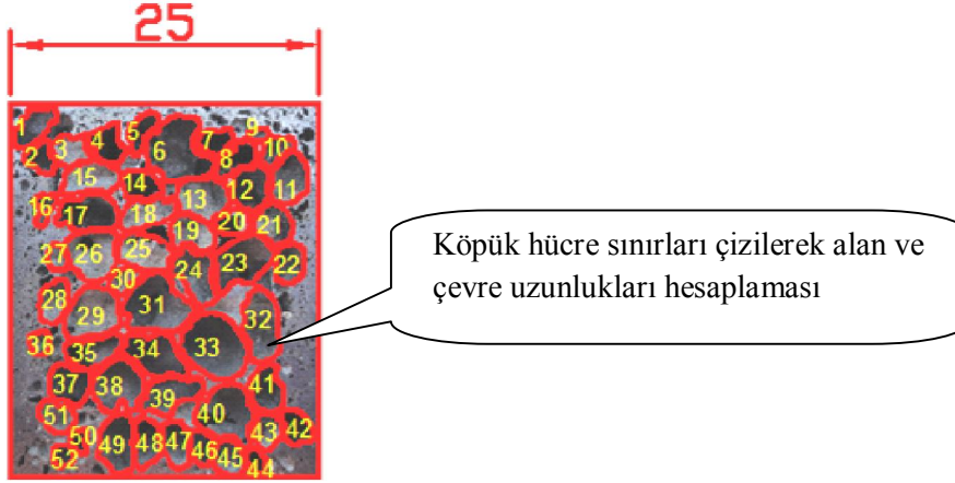
Şekil 4.7. Köpük numune görüntüsü üzerinde AutoCAD programı ile alan oluşturma, alan ve çevre hesaplaması.
