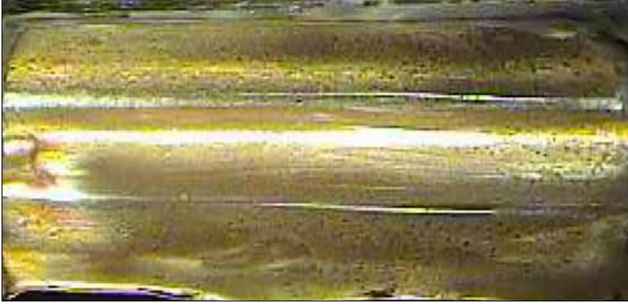
Resim 3.5. Öngerilmeli kaynak dikişinin yüksüz durumda fotoelastik görüntüsü [Çevik, 2009].
