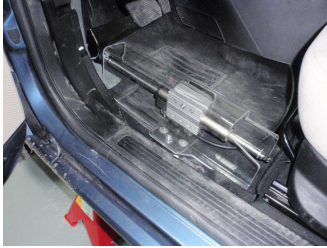
Şekil 3.17 : Lineer motorun mekanik bağlantısı.
