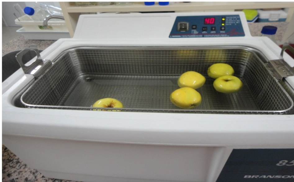
Şekil 2.8. P. expansum ile inokule edilmiş elmalara SC uygulaması.
