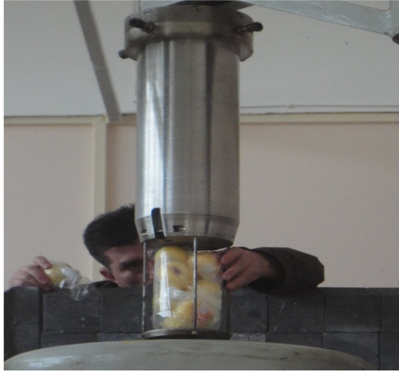
Şekil 2.9. P. expansum ile inokule edilmiş elmaların ışınlaması.
