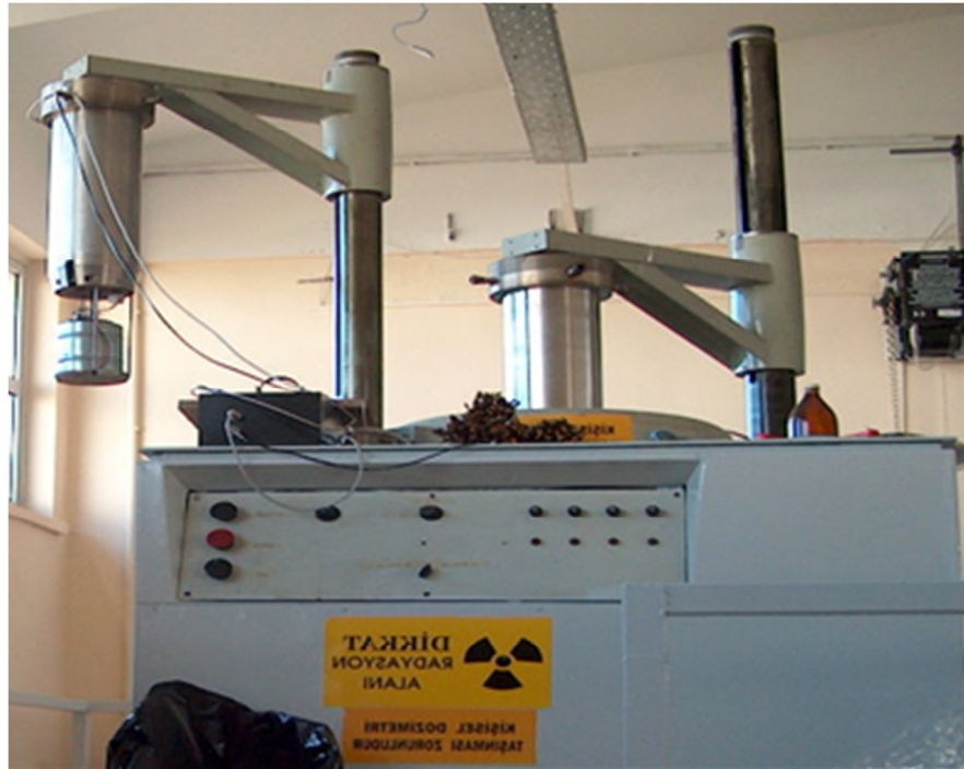
Şekil 2.5. Araştırmada kullanılan TAEK-SANAEM'de bulunan ^{60}\text{Co} gamma kaynağı.
