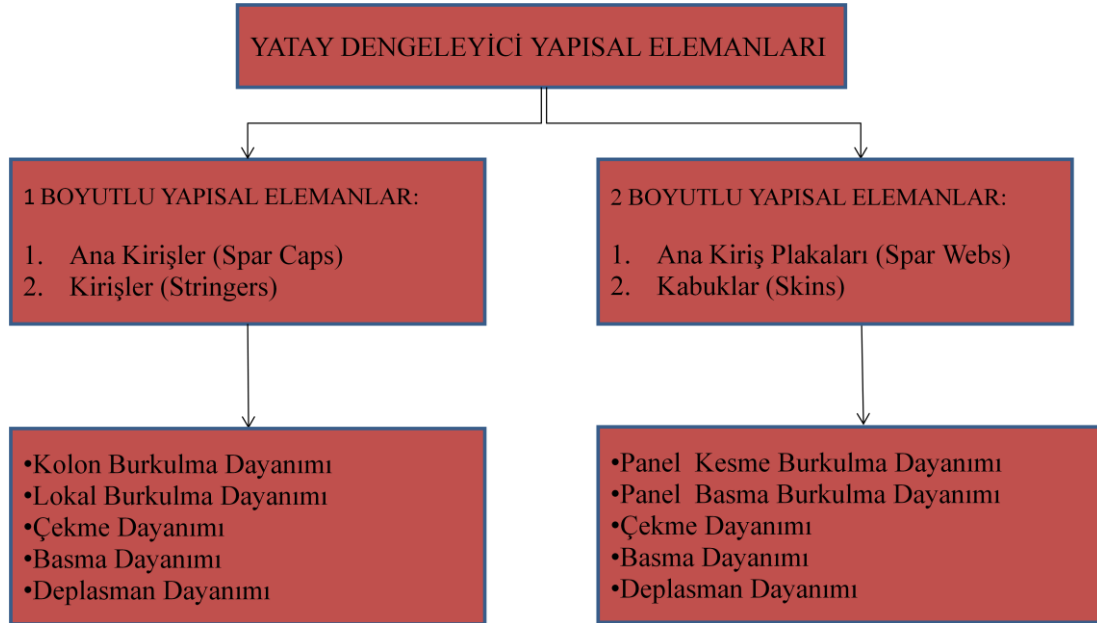
Şekil 4.1. Yapısal Elemanların Bozulma Kriterleri
