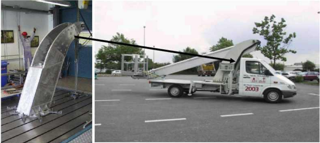
Resim2.3 Alüminyum sandviç panelden yapılmış bir kaldırma kolu.
