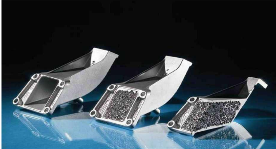
Resim 2.5 motor bloğu montaj parçaları, soldan sağa; boş döküm, alüminyum köpük çekirdek içeren yekpare parça, kesit görüntü.
