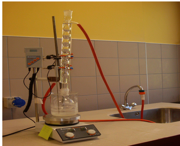
Şekil 3.1. Membran çözeltisi hazırlama düzeneği
