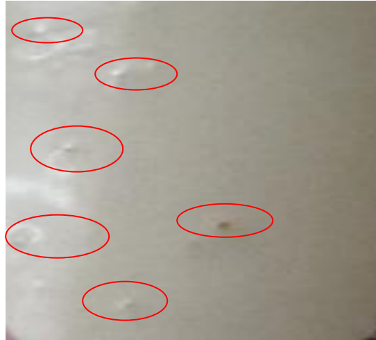
Şekil 6.49. 1250°C - 830 dak. rejiminde pişirilmiş T1011'da gözlemlenen kabarcıklaşma hatası (kabarcıklar elips içinde gösterilmiştir)
