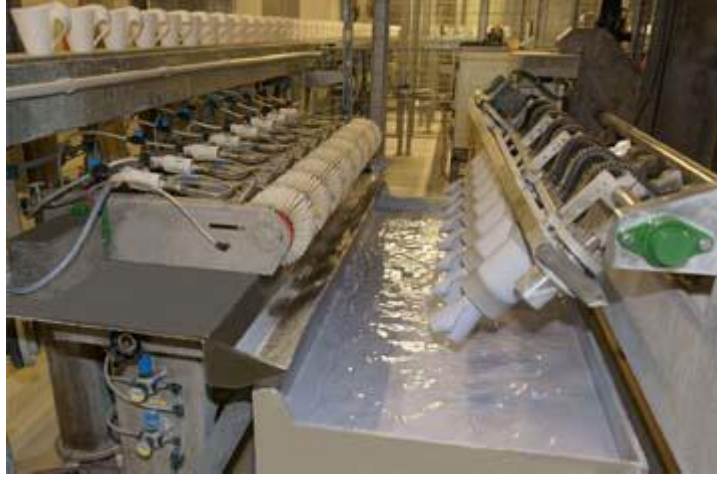
Şekil 4.7. Daldırma yöntemi ile sırlama örneği
