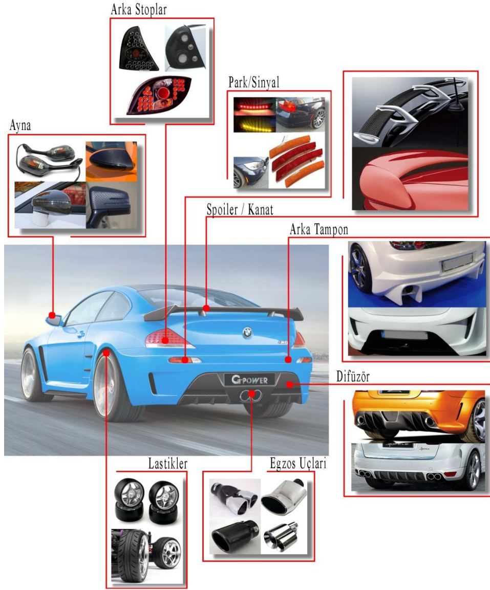
Şekil 3.3: Araç dışı/gövde dönüştürme unsurları (Haz. Selen Devrim Ülkebaş).
