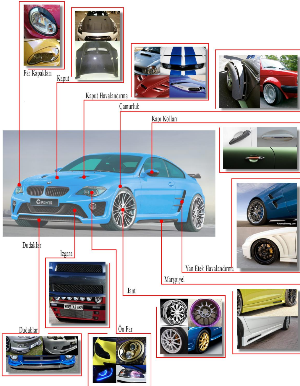
Şekil 3.2: Araç dışı/gövde dönüştürme unsurları (Haz. Selen Devrim Ülkebaş).
