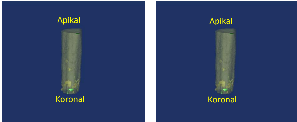
Resim 3.2.1.6. MTA'nın mekanik yükleme öncesi ve sonrası 3 boyutlu model görüntüsü. Boşluklar yeşil, dolgu materyali sarı olarak görüntülenmiştir.
