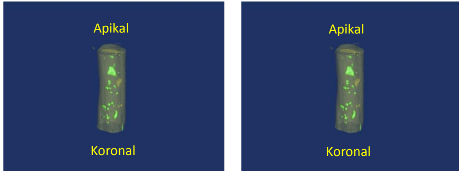
Resim 3.2.1.1. Super EBA'nın mekanik yükleme öncesi (solda) ve sonrası (sağda) 3 boyutlu model görüntüsü.
