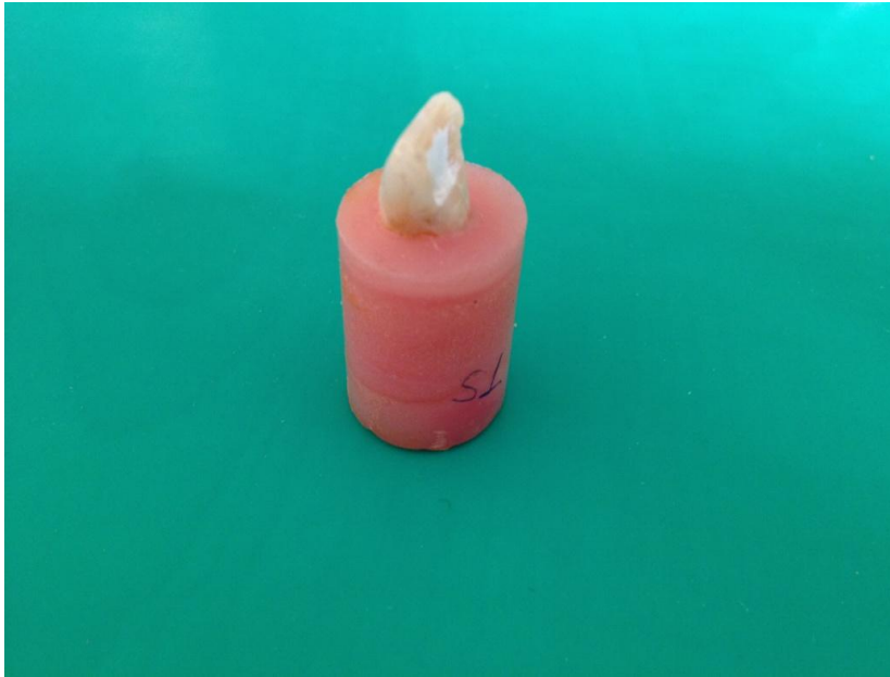
Resim 2.3.1. Mekanik yükleme için akrilik bloğa yerleştirilen örnek.
