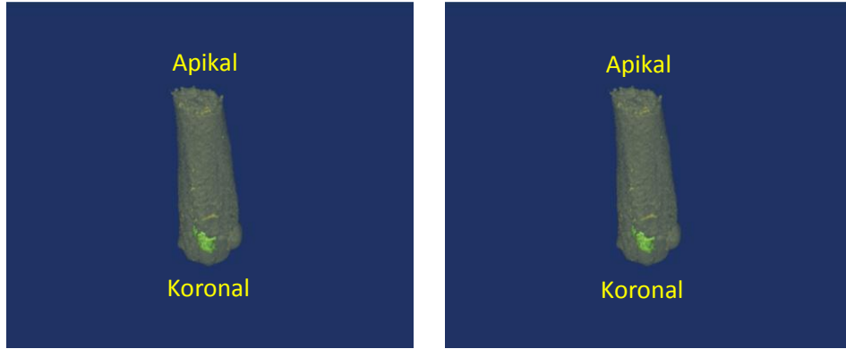
Resim 3.2.1.7. TechBiosealer'a ait mekanik yükleme öncesi ve sonrası 3 boyutlu model görüntüsü.
