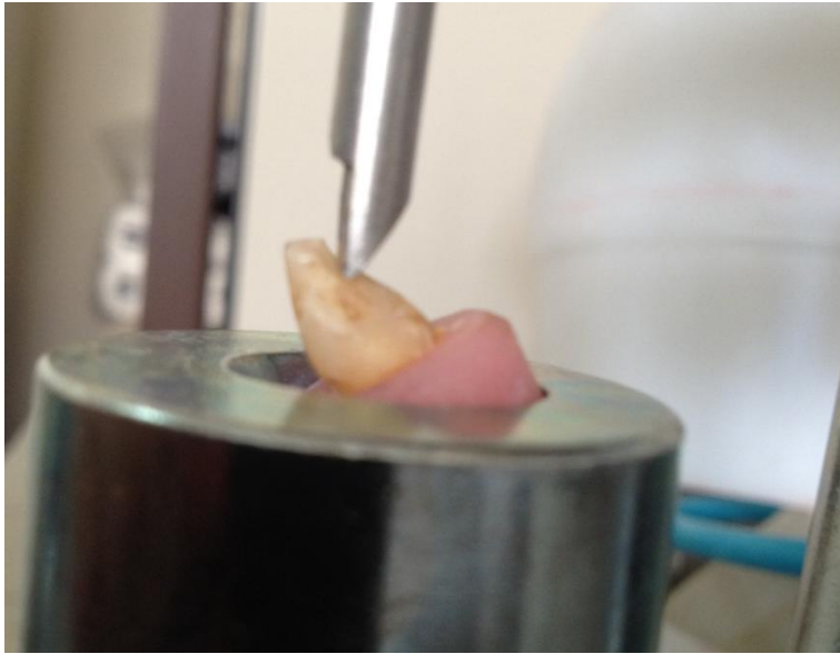
Resim 2.3.3. Çiğneme simülatörüne yerleştirilen örneğin görüntüsü.
