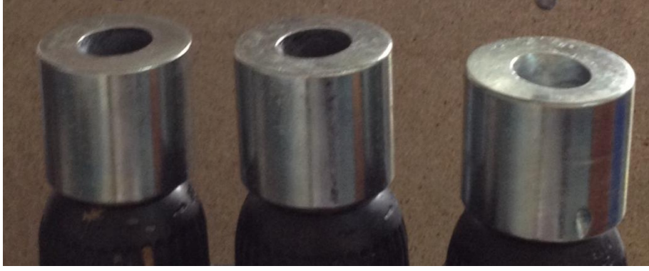
Resim 2.3.2. Çiğneme simülatörü cihazına adapte edilebilen paslanmaz çelik kalıplar.
