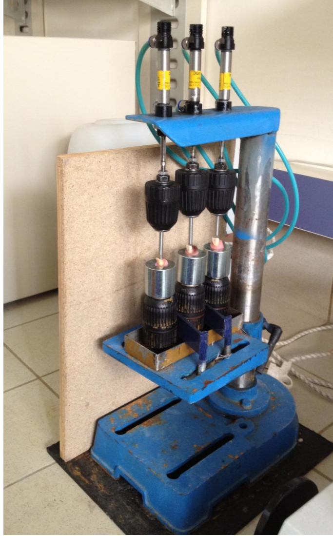
Resim 2.3.4. Çiğneme simülatörü cihazı.
